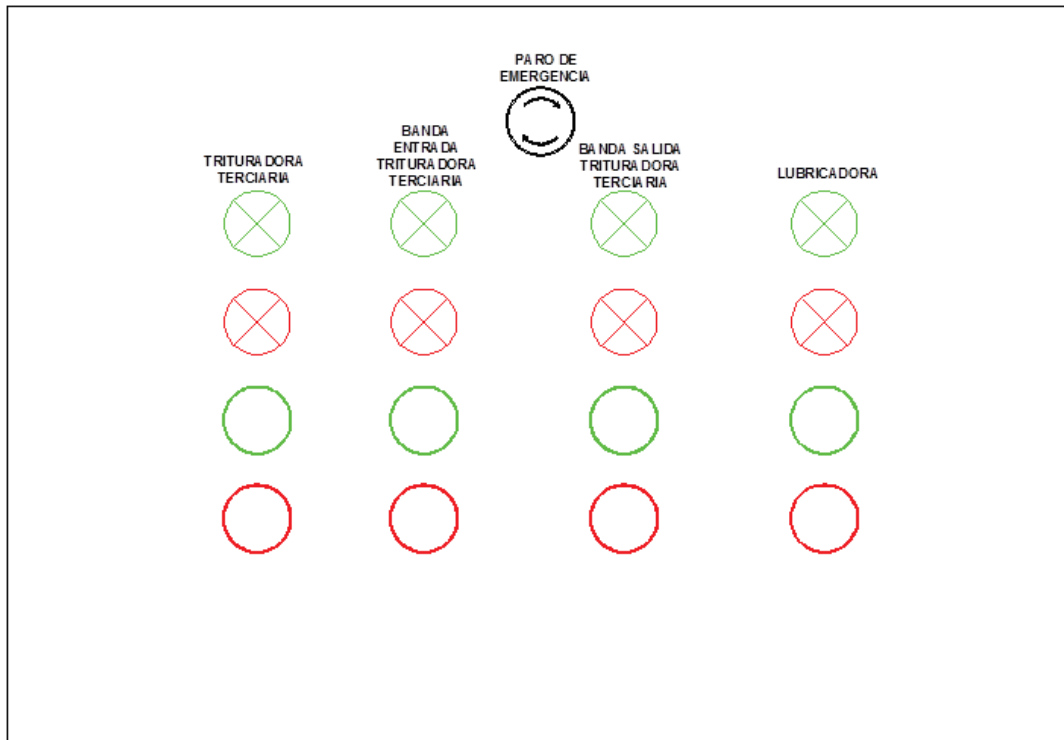
Figura 2. 40: Esquema de montaje de los pulsadores y luces piloto de la trituradora terciaria.
