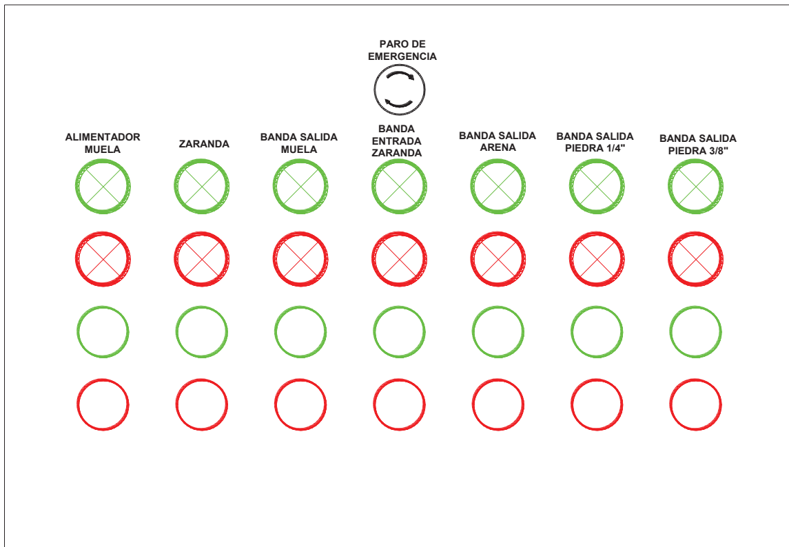
Figura 2. 30: Esquema de ubicación de las botoneras y luces piloto del tablero de control.
