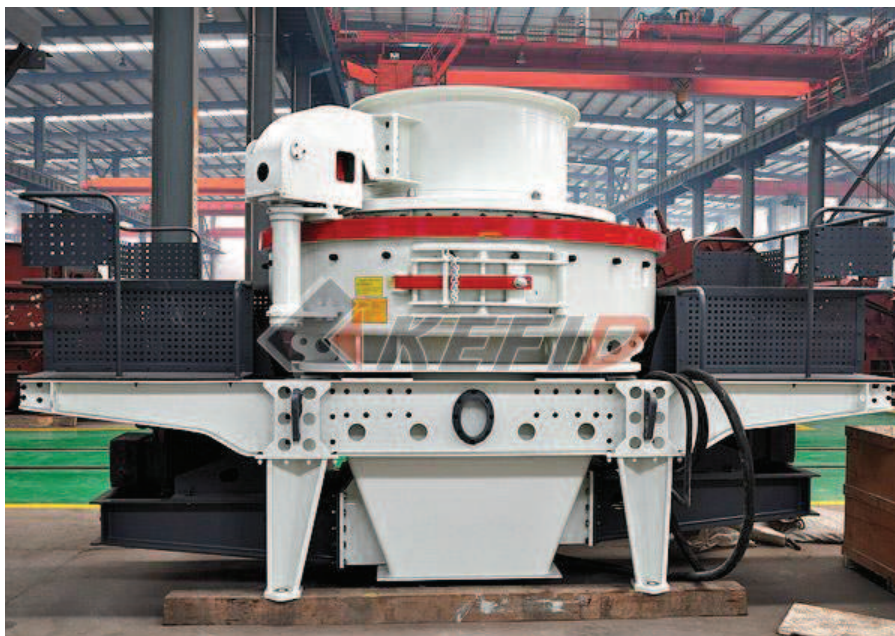
Figura 1. 17: Trituradora de impacto de eje vertical con cámara profunda
