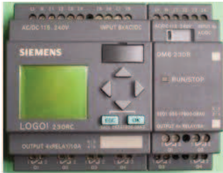
Figura 2. 5: Logo! 230RC con módulo de expansión utilizado en el tablero de control.
