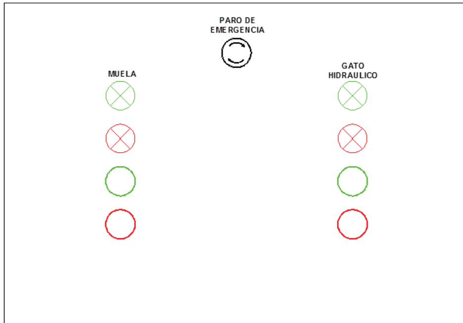
Figura 2. 34: Esquema del montaje de los pulsadores en la puerta del tablero trituradora primaria.
