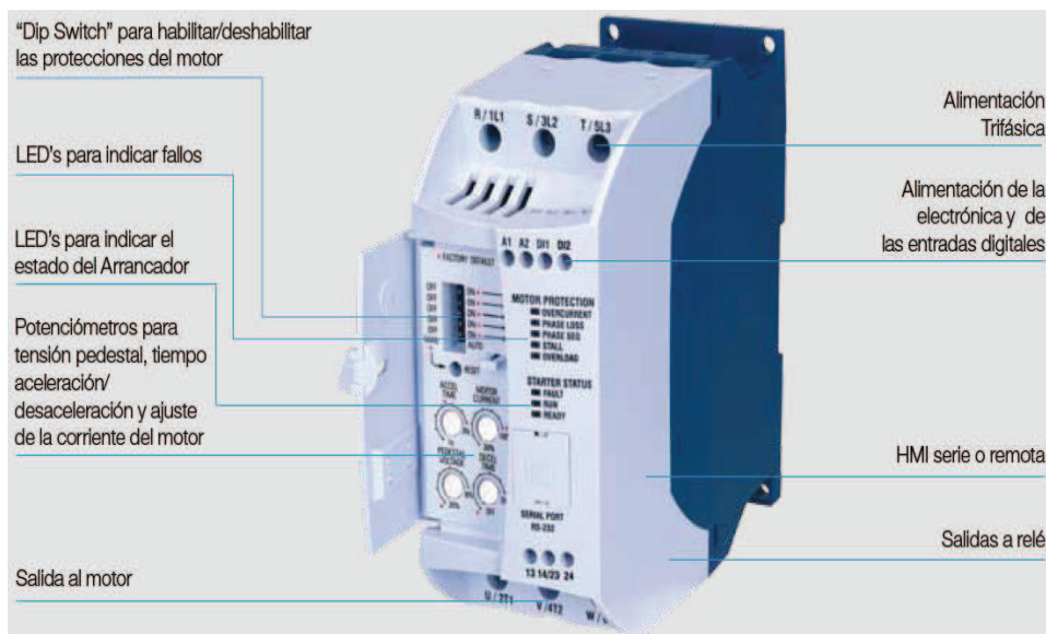
Figura 3. 23: Descripción del Soft Starter SSW05.
