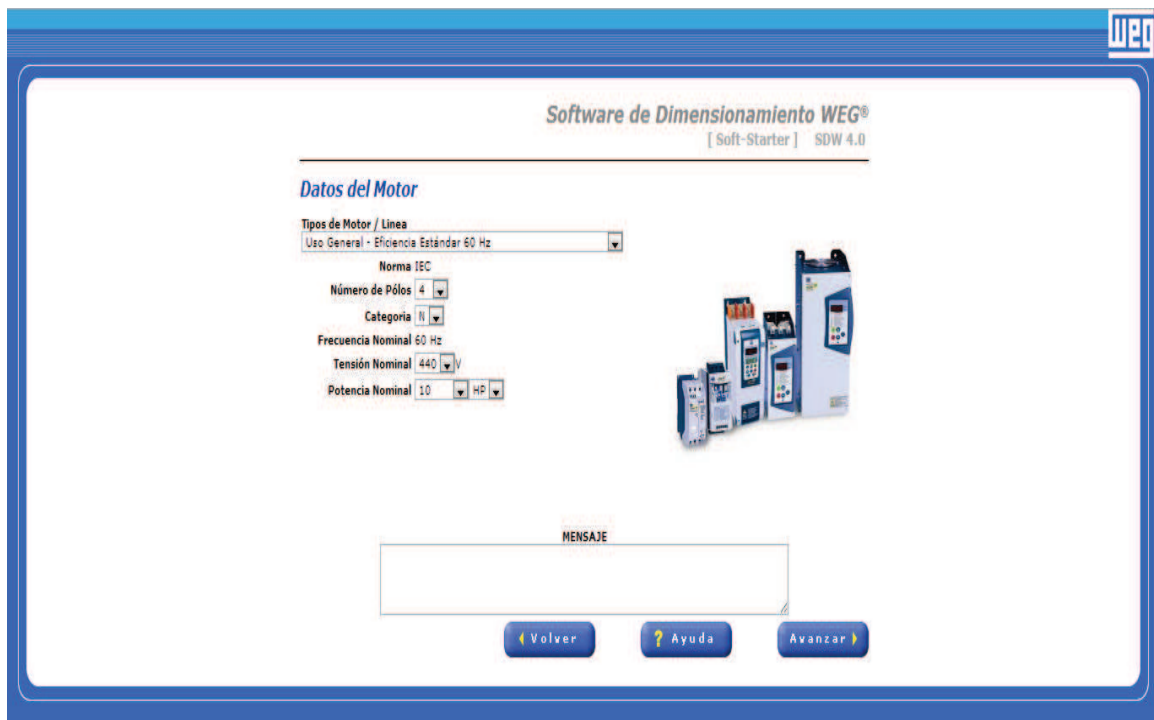
Figura 2. 16: Ingreso de los datos del motor en el software de dimensionamiento WEG.
