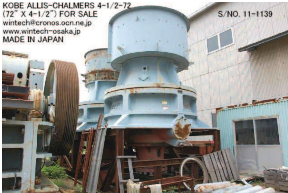
Figura 1. 7: Trituradora giratoria de 72 pulgadas de apertura.
