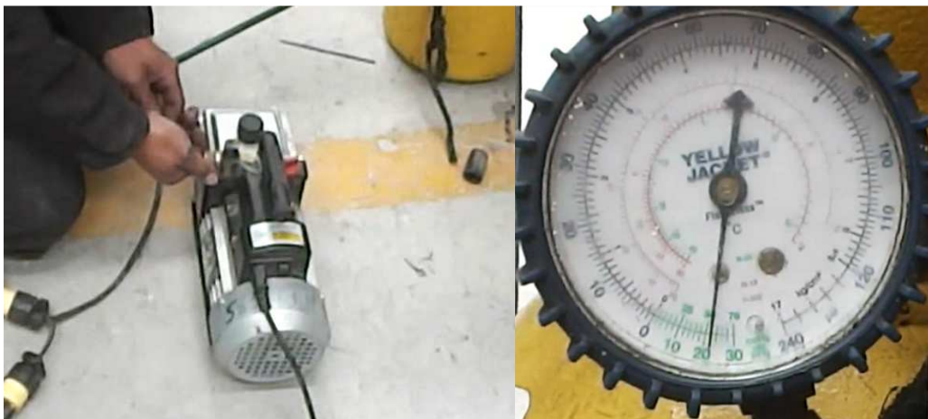
Fig. 70.- Puesto a hacer vacío visualizado en manómetro Archivo fotográfico personal
