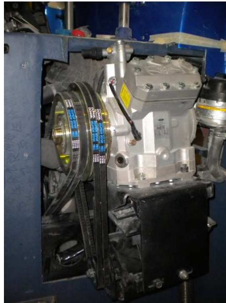
Fig. 16.- Compresor posición derecha, alineación de poleas y ajuste de bandas Archivo fotográfico personal
