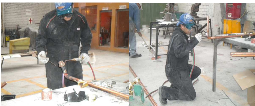
Fig. 32.- Soldaduras de plata 5-15 % (suelda autógena) Archivo fotográfico personal
