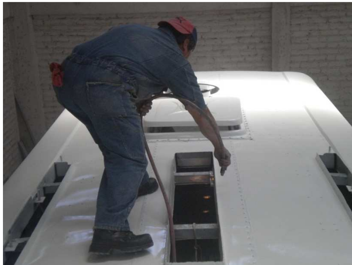
Fig. 17.- Orificios de techo listos para montaje de evaporador Archivo fotográfico personal
