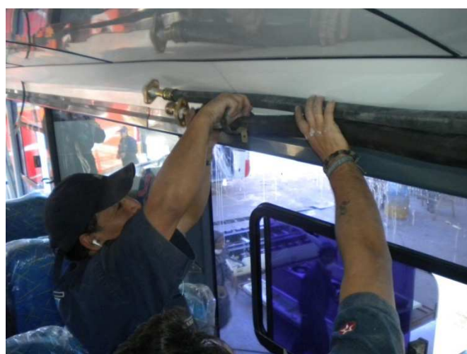
Fig. 43.- Aseguramiento de mangueras con abrazaderas Archivo fotográfico personal
