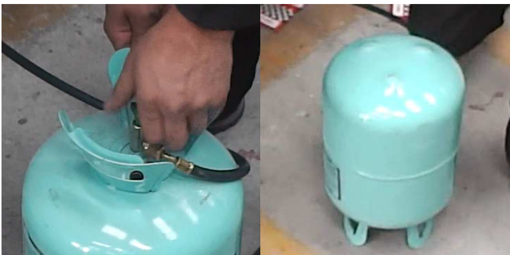
Fig. 71.- Preparación de carga de refrigerante R 134 a Archivo fotográfico personal
