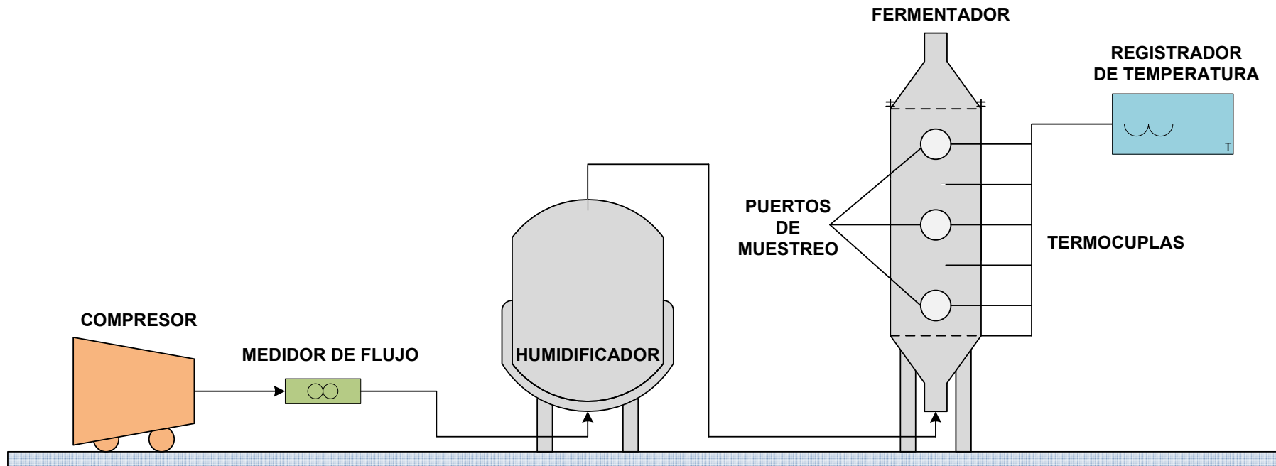
Figura 3.19. Esquema del sistema de producción de amilasa por fermentación sólida a escala piloto
