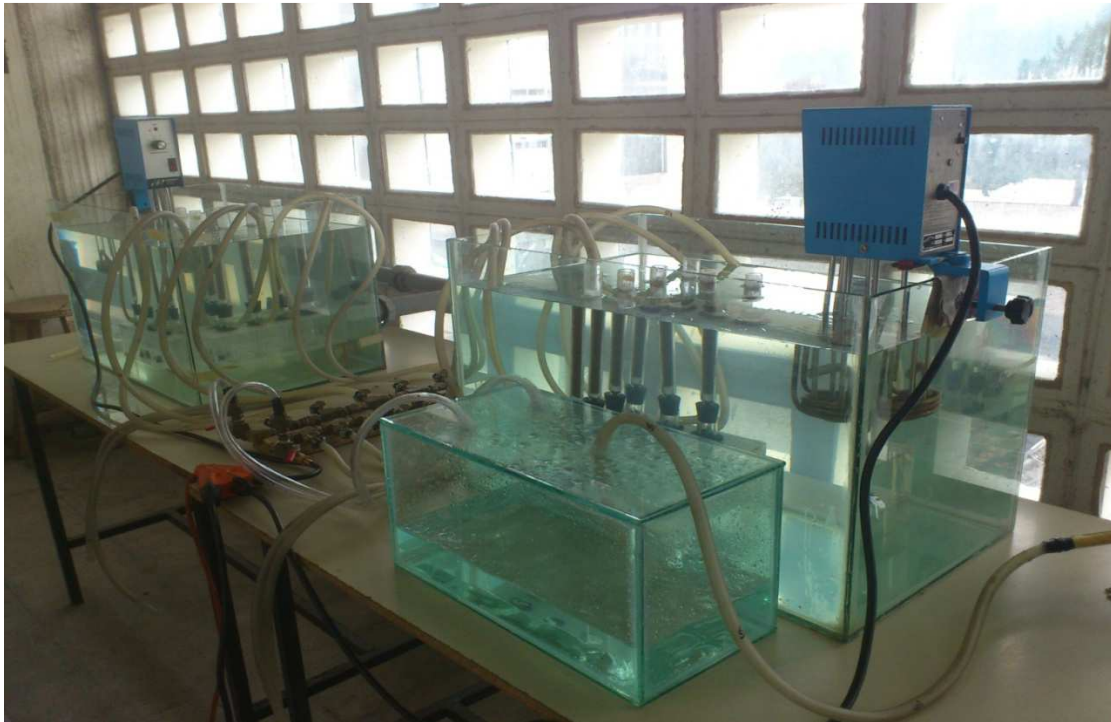
Figura 2.2. Esquema del sistema de biorreactores empleados para la fermentación
