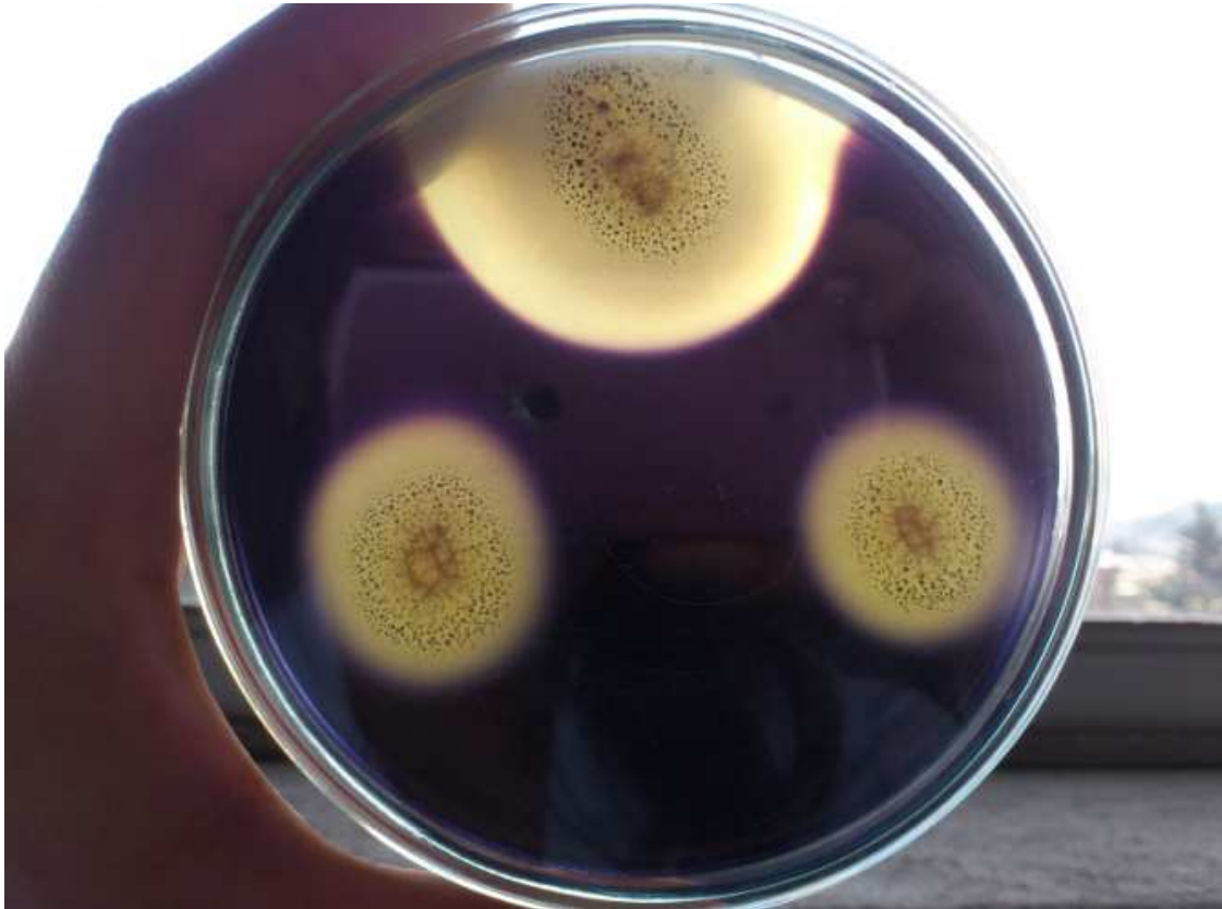
Figura 3.2. Prueba de lugol para la determinación cualitativa de la producción de enzima amilasa
