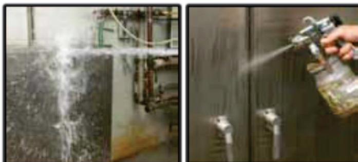
Fig.2.9 Prueba de agua dirigida con manguera Tipo 4 Fig.2.10 Prueba de agua atomizada Tipo 12
