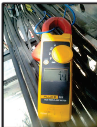
Fig.6.9 Carga en circuito de luminarias de mercurio halogenada.
