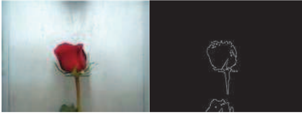
Figura 3.14 (a) Imagen original; (b) imagen aplicada el filtro de canny
