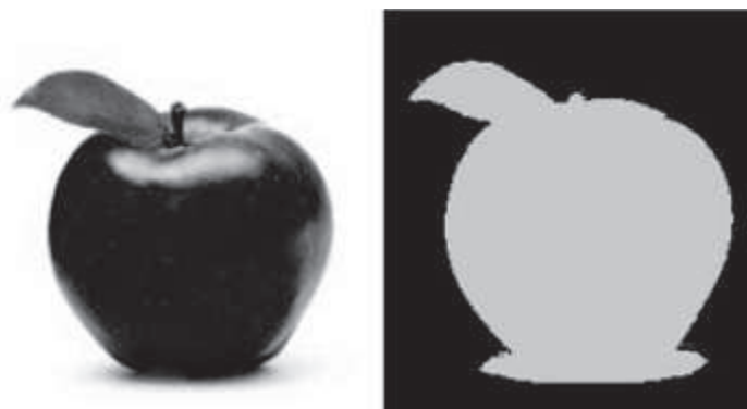
Figura 1.16 Umbralización de una imagen [19]
