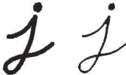
Figura 1.23 (a) Imagen original; (b) Imagen dilatada [19]
