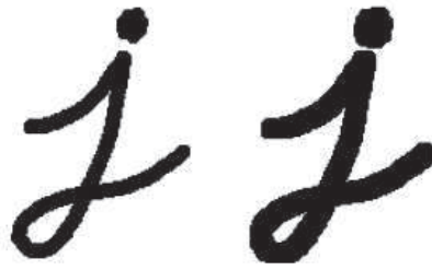
Figura 1.24 (a) Imagen original; (b) Imagen erosionada [19]
