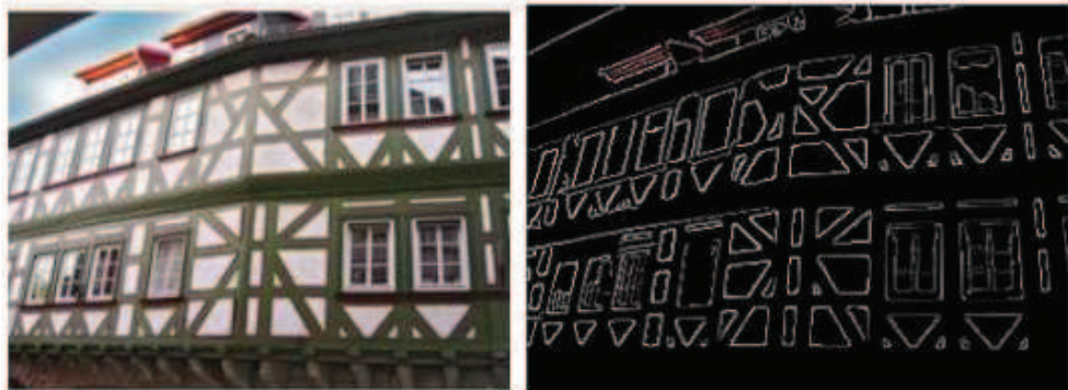
Figura 1.27 (a) Imagen original; (b) Imagen con filtro de Canny [19]
