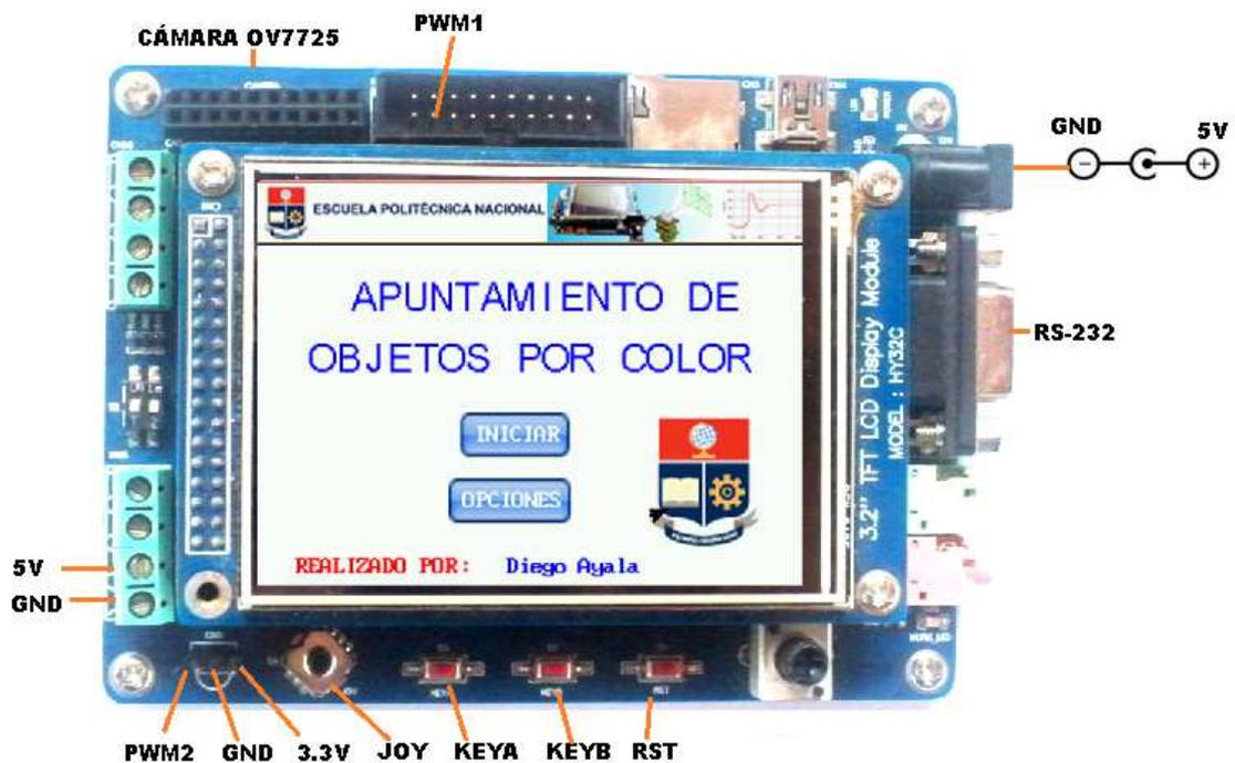
**Gráfica 2** Tarjeta electrónica del sistema de visión.
