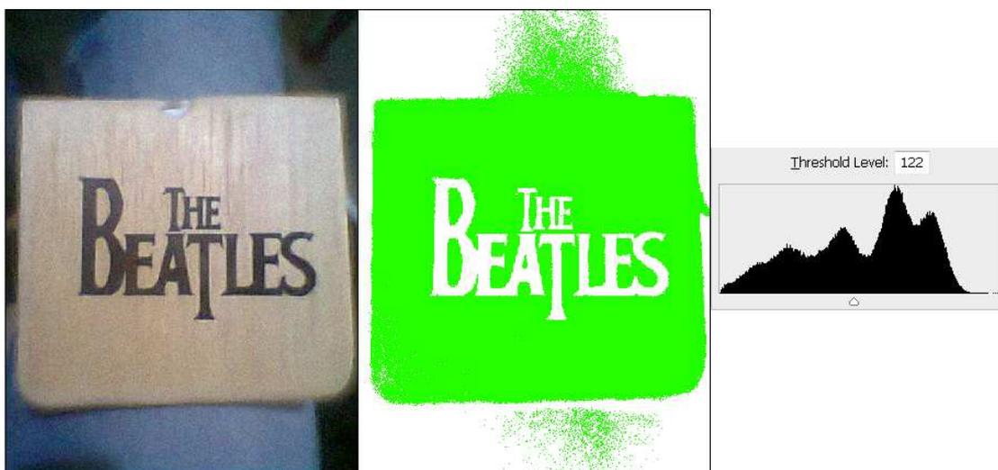
**Figura 1.12** (a) Imagen original, (b) Imagen binarizada, (c) Nivel de umbral empleado.
