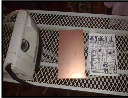
Fig. 3.16 Pistas a transferirse a la placa.
