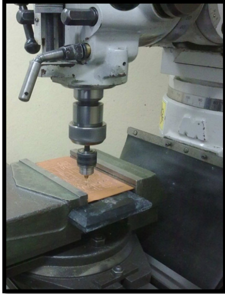
Fig. 3.18 Maquinado de las perforaciones de la placa
