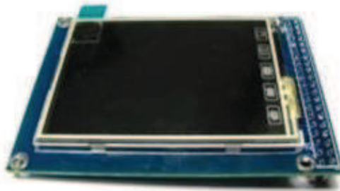
Figura 2.17 TFT LCD con pantalla de 3.2"
