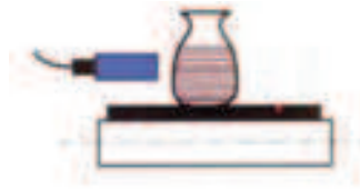
Figura 2.6 Sensado de nivel a través de cristal [14]
