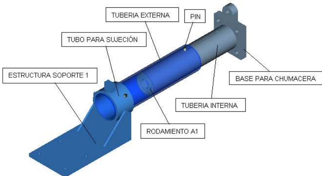
Figura 4. 18 Sistema de tubos para avance
