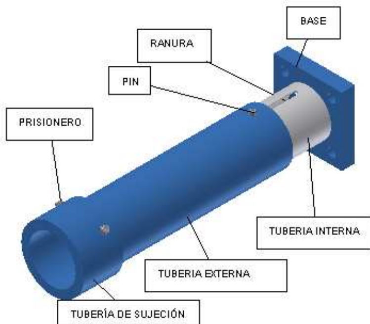
Figura 3. 8 Sistema de tubos
