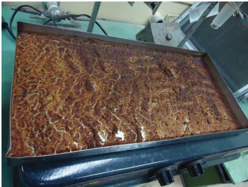
Figura AXII. 1. Pasta de soya hidrolizada, secado en bandejas
