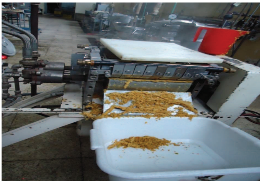
Figura AXII. 2. Pasta de soya hidrolizada, secado por rodillos
