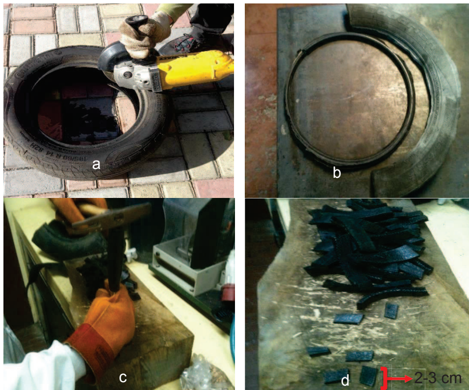
Figura 2.3. (a) Corte de los neumáticos para la reducción de tamaño (b) Destalonado y desbandado; (c) Troceado de la banda lateral; (d) Caucho de NFU's troceado ( d_p=2-3 cm)
