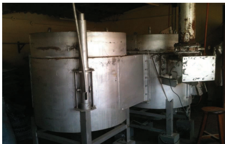
Figura 2.6. Horno Nichols-Herrshoff mono solera (De la Torre et al., 2007, p. 27)
