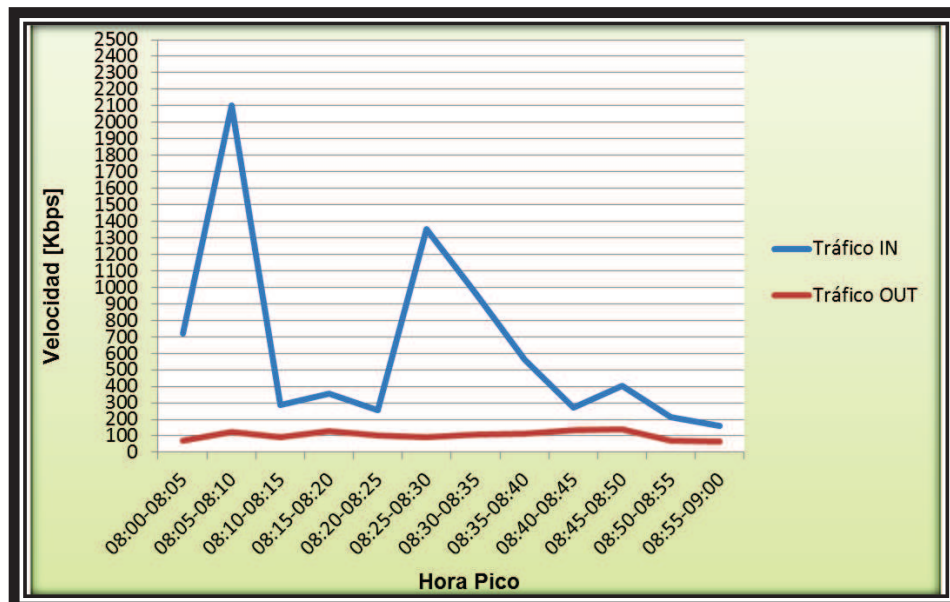
Figura 2.10 Tráfico de entrada y salida en la hora pico
