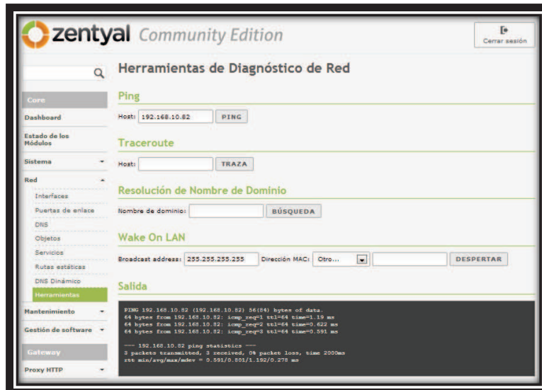
Figura 4.13 Prueba de conectividad hacia la VLAN Radioenlace (Antena I)
