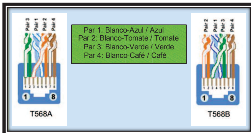
Figura 1.5 Formas de conexión T568A y T568B [11]
