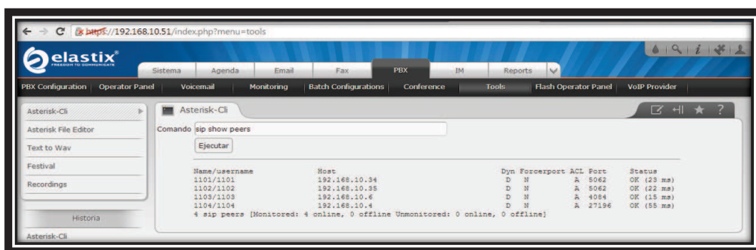
Figura 4.32 Registro de extensiones SIP en la PBX
