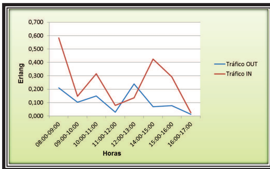
Figura 2.22 Tráfico telefónico en Erlangs en el periodo de un día
