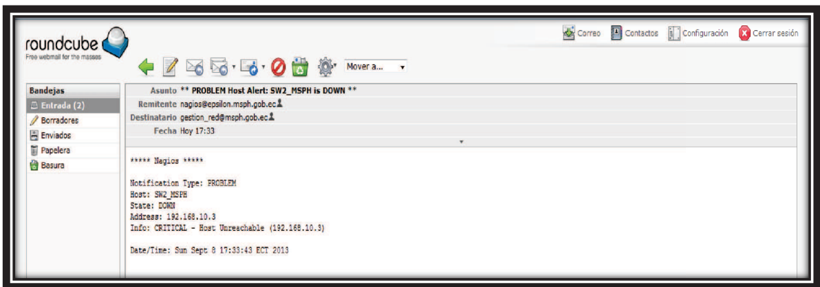
Figura 4.48 Notificación de alerta del dispositivo SW2_MSPH
