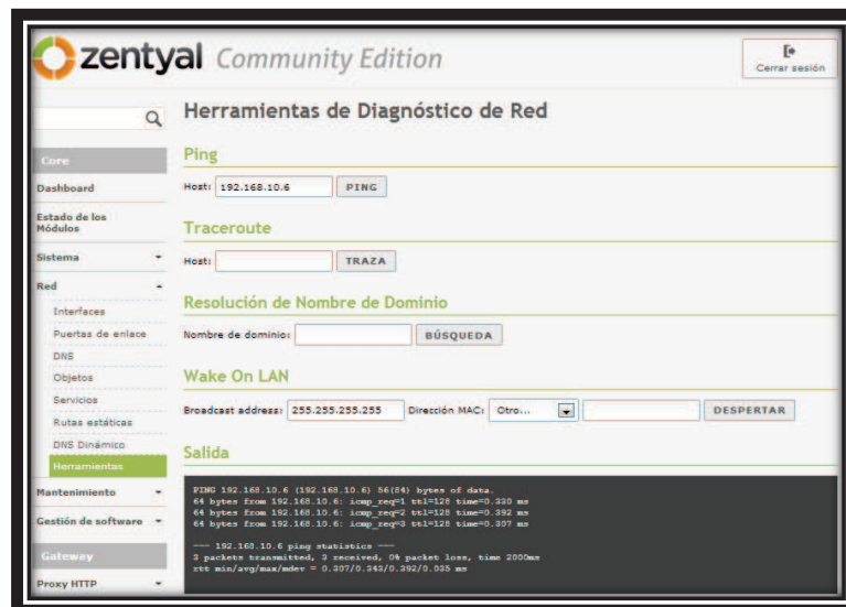
Figura 4.12 Prueba de conectividad hacia la VLAN de Datos
