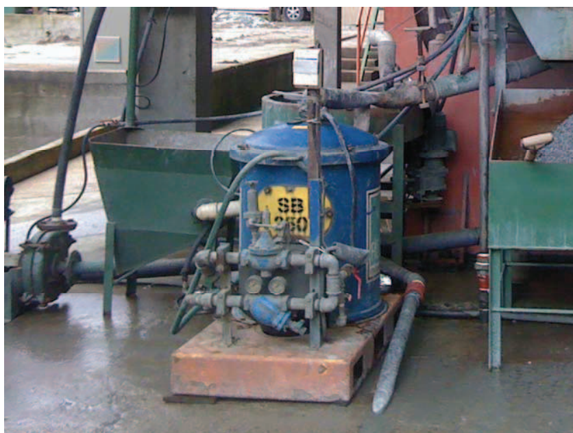
Figura 1.18 Concentrador gravimétrico FALCON SB 250
