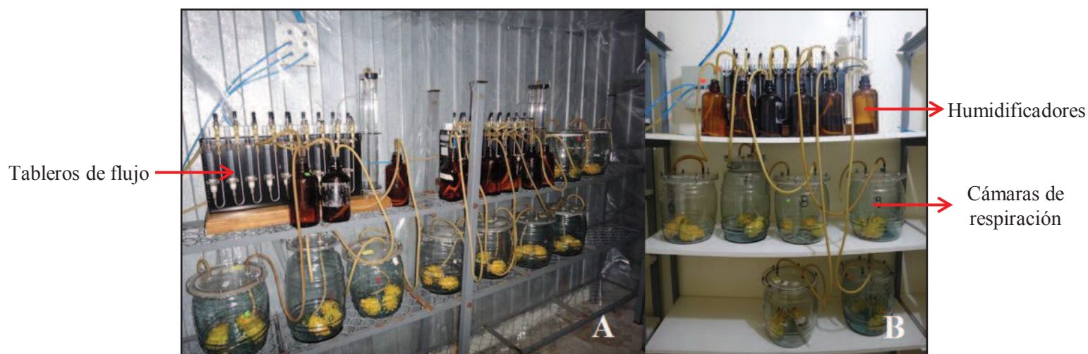
Figura AVIII.2. Tableros de flujo, humidificadores y cámaras de respiración almacenadas en el cuarto frío (A) y a temperatura ambiente (B)
