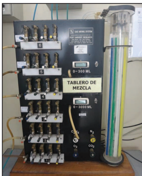
Figura AVIII.1. Fotografía del tablero de mezcla del sistema de respiración
