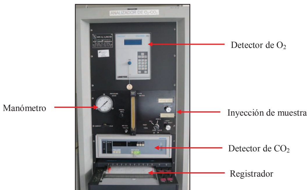
Figura AVII.1. Fotografía del analizador rápido de CO 2 -O 2 y sus partes principales
