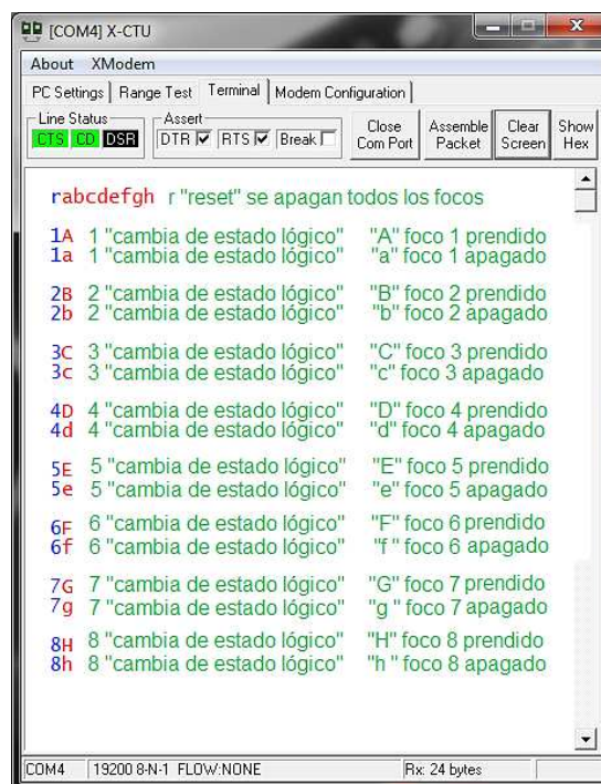
Figura 3.13. Prueba de control de las luminarias de la vivienda.
