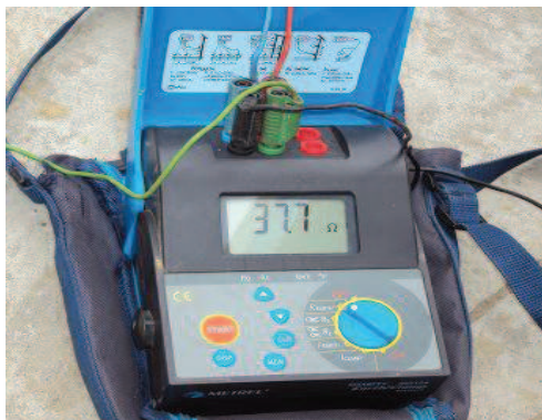
Figura 34 Telurómetro METREL (Earth Tester KMI 2124)
