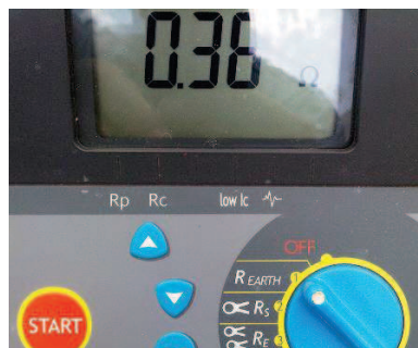
Figura 37 Medición de la resistividad con la ayuda del TELURÓMETRO
