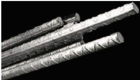
Figura 10 Varillas de Hierro o Acero usadas en la Construcción de Edificios.
