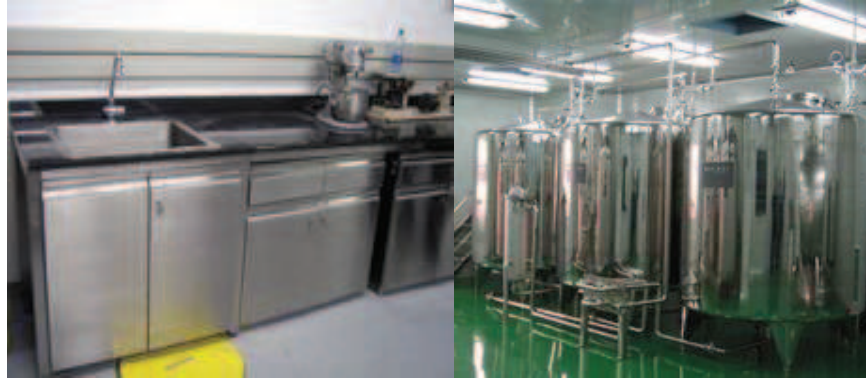
a) Electrodomésticos b) Tanques de Almacenamiento Figura 1.7 Algunas Aplicaciones del acero AISI 304L 12,13
