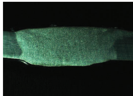
Macrografía AISI 316L sin precalentamiento.
