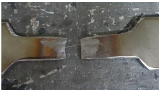
Figura 4.14 Probeta luego de aplicar el ensayo de tensión.
