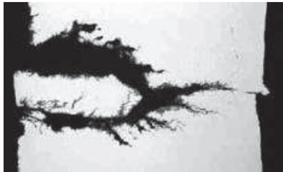
Figura 3.5 Corrosión Bajo tensión. 49
