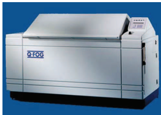
Figura 3.6 Cámara salina. (Q-FOG-CCT-600, EPN, 2013) 54
