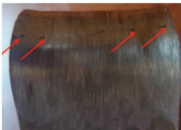
Figura 5.2 Doblado de cara AISI 316L sin precalentamiento.
