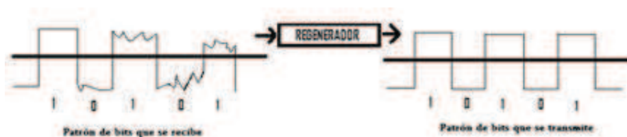
Figura 1.17 Bloque Regenerador y Principio de Regeneración 26
