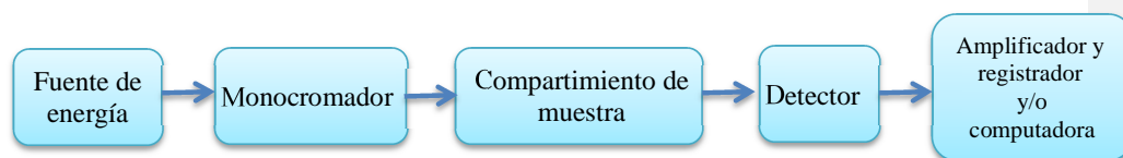
Figura 2. 9 Diagrama de los componentes principales de un espectrofotómetro
