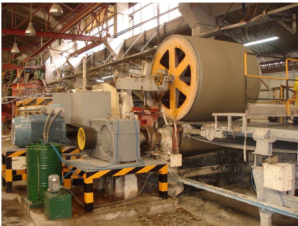
Figura 1. 10 Rodillo laminador, caja reductora y motor de inducción
