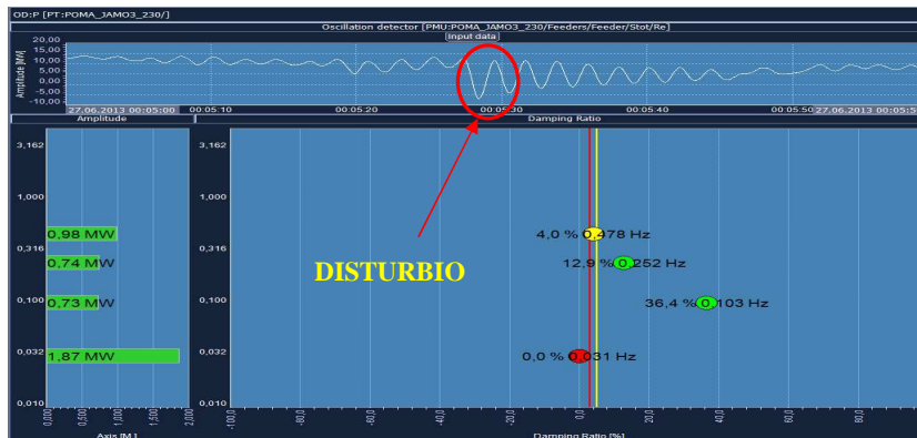
Figura D.7: Señal de potencia activa, modos oscilatorios en WAProtector.
