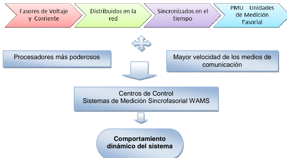
Figura 2.7: Funciones principales de la PMU [36].
