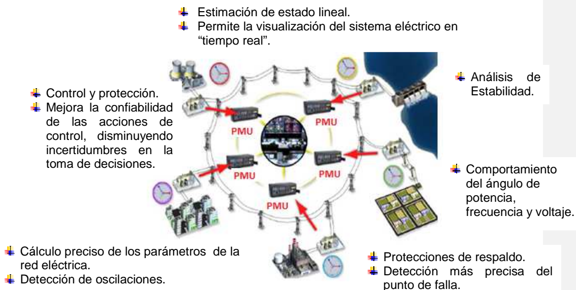
Figura 2.15: Aplicaciones generales de las mediciones sincrofasoriales [18].
