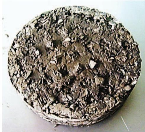
**Figura 3.11** Pastilla de lutita luego de la prueba de dureza al humectar con la formulación 9 para la sección 8 ½”
