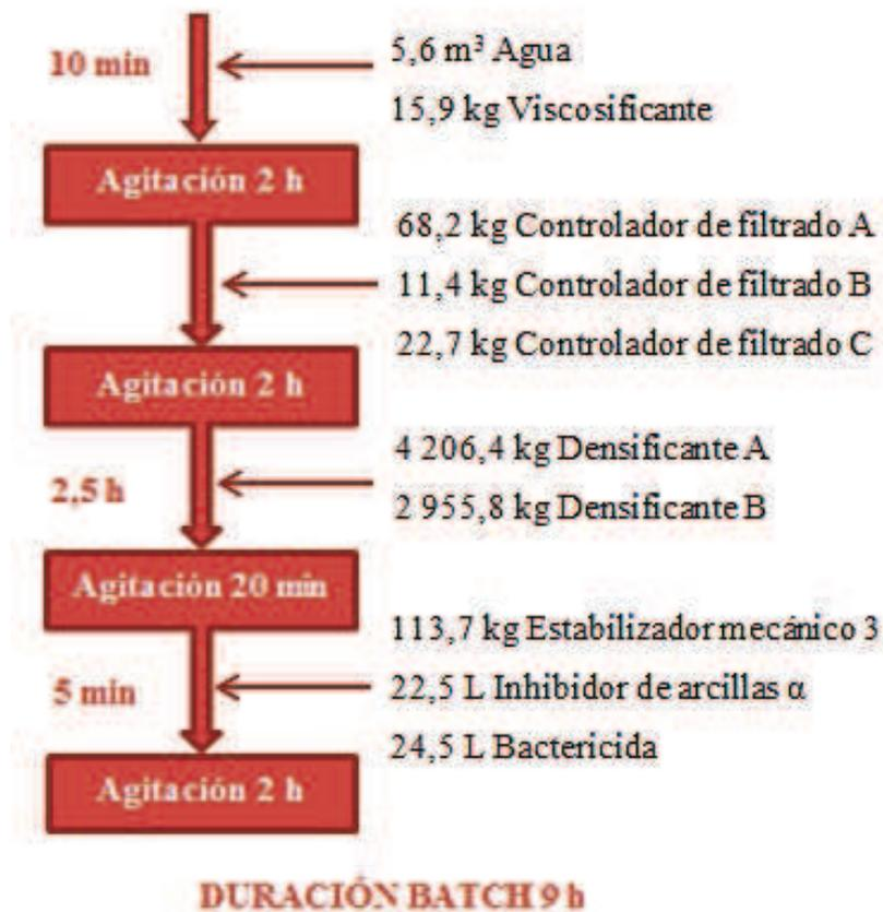
**Figura 3.20** Diagrama del proceso de mezclado para la preparación del fluido seleccionado para la sección 8 1/2"
