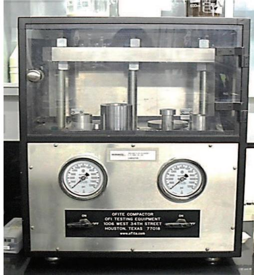
**Figura 2.4** Fotografía del compactador OFITE, modelo #150-82
