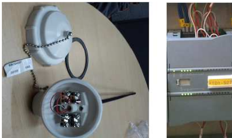
Figura 2.19 PT100 3 hilos y módulo RTD de señales 2 .
