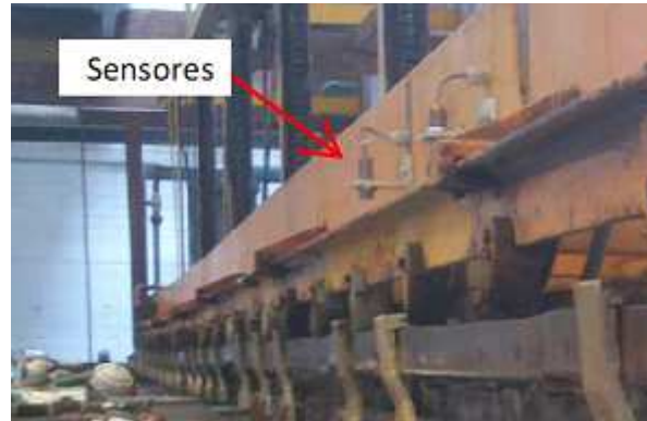
Figura 4.14 Calibración de sensores. 2
