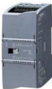
Figura 2.26 Módulo de señales analógicas.
