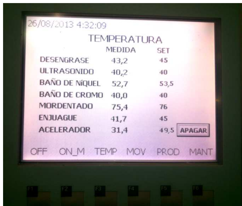
Figura 4.19 Pantalla de temperatura medida e ingresada 18 .
