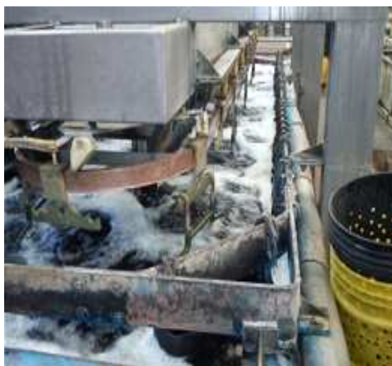
Figura 1.8 Cuba de cobre ácido 2 .
