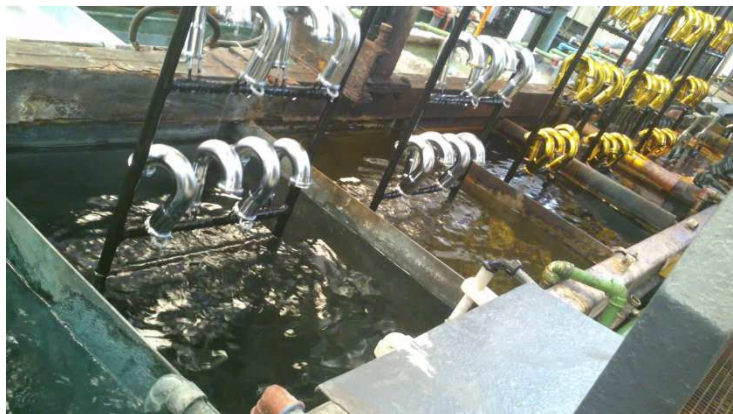
Figura 1.12 Enjuague de agua desmineralizada en cascada 2 .
