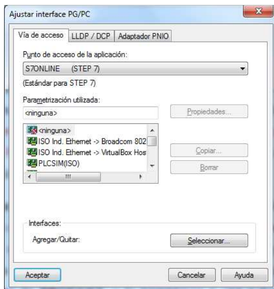
Figura 3.6 Ajuste de interface PG/PC. 17
