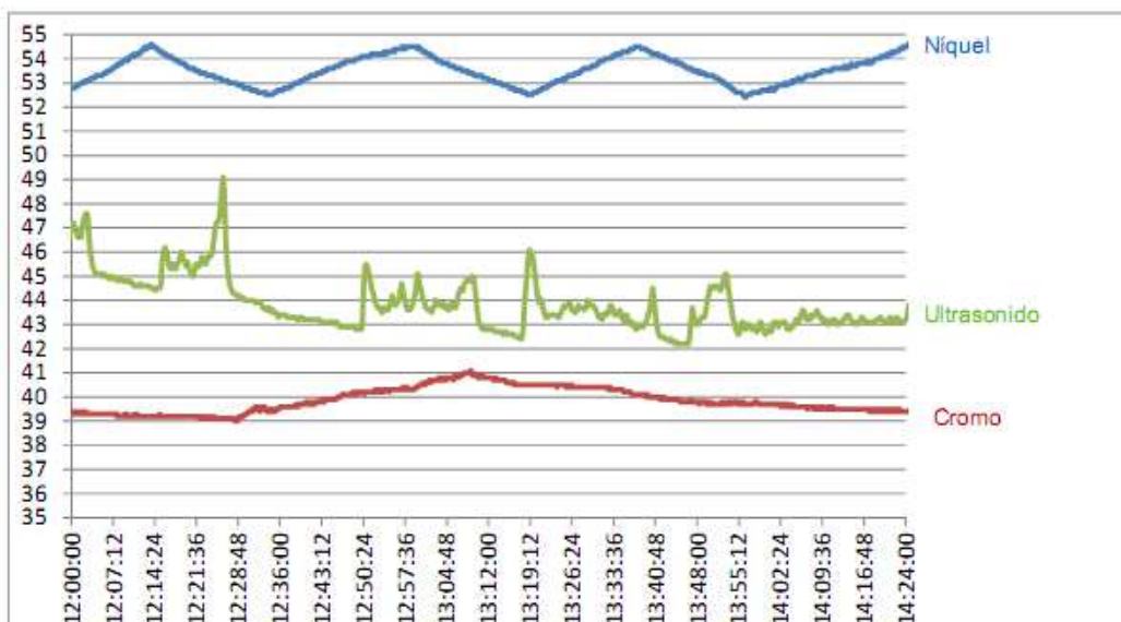
Figura 4.17 Curva real de temperatura níquel, ultrasonido y cromo.
