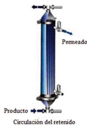
Figura 1.11. Representación de un módulo de membrana en diseño de fibra hueca Fuente: Bylund, 2003, p 128
