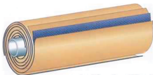
Figura 1.7. Representación de un módulo de membrana en sentido espiral
