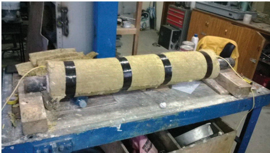
Figura 4-22 Colocación de fibra mineral de roca
