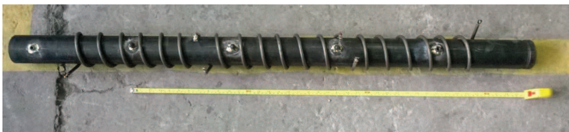
Figura 4-17 Posicionamiento de Resistencias Eléctricas en tubería
