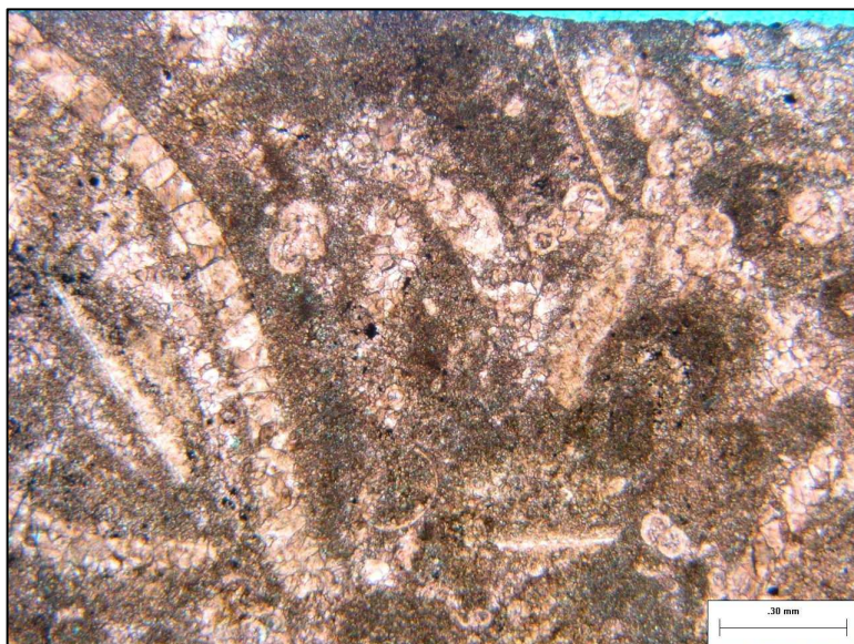
Figura 39. Ripios analizados en el Miembro Caliza A que muestran Wackestones/packstones recristalizados. Escala: 0.30 mm (Petrobrás, 2006).
