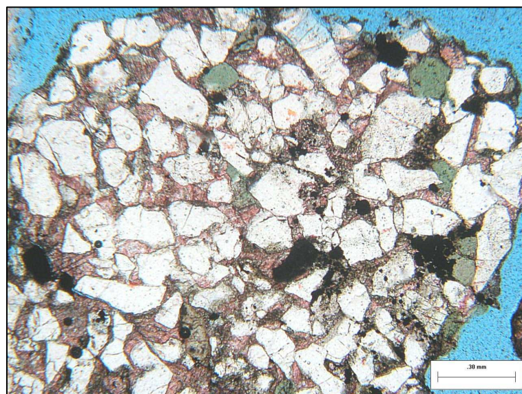
Figura 34. Areniscas con cemento calcítico y glauconita. Escala: 0.30 mm. (Petrobrás, 2006).
