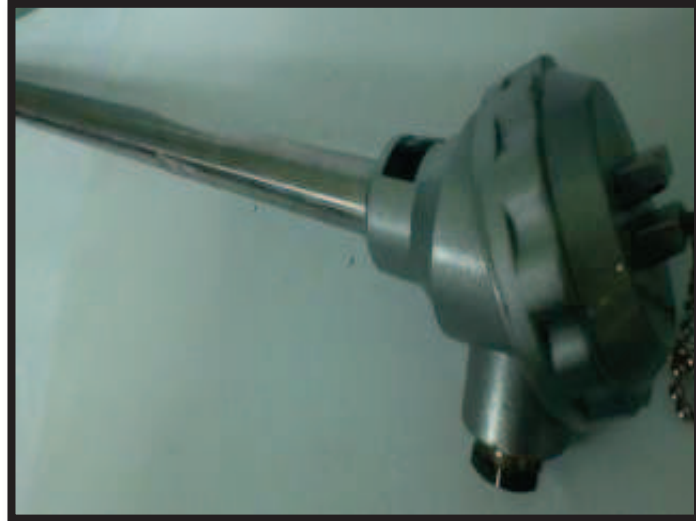
Figura 2.11 Cuerpo de la termocupla incorporada.
