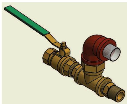
*Figura 4-22 Toma de aire del motor Stirling*
