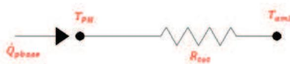
Figura 3-12 Circuito de Resistencias simplificado.
