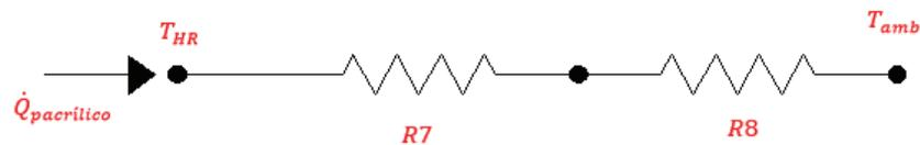
Figura 3-17 Circuito de resistencias térmicas en la pared de la cámara de aire.
