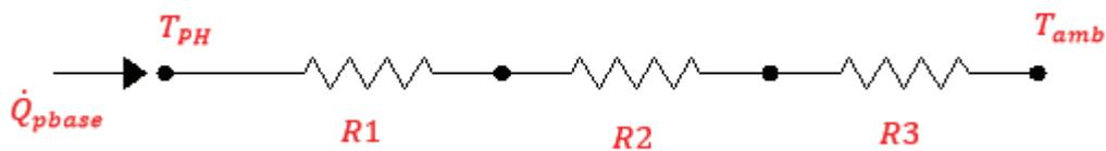
Figura 3-11 Circuito de Resistencias Térmicas.
