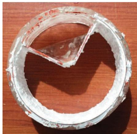
*Figura 4-8 Molde de acrílico para el desplazador de poliuretano 1-3.*
