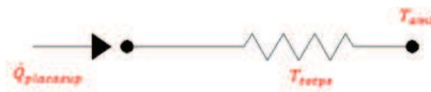
Figura 3-15 Circuito de resistencias térmicas simplificado para la placa superior.
