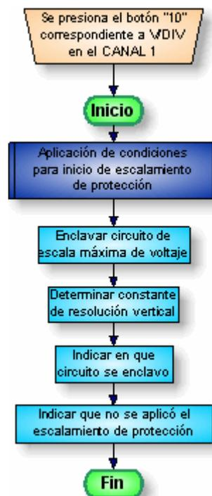
Figura 4.14 Evento de escalamiento de voltaje en 10 V/DIV para el canal 1.
