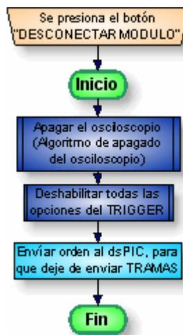
Figura 4.10 Desconexión del módulo.
