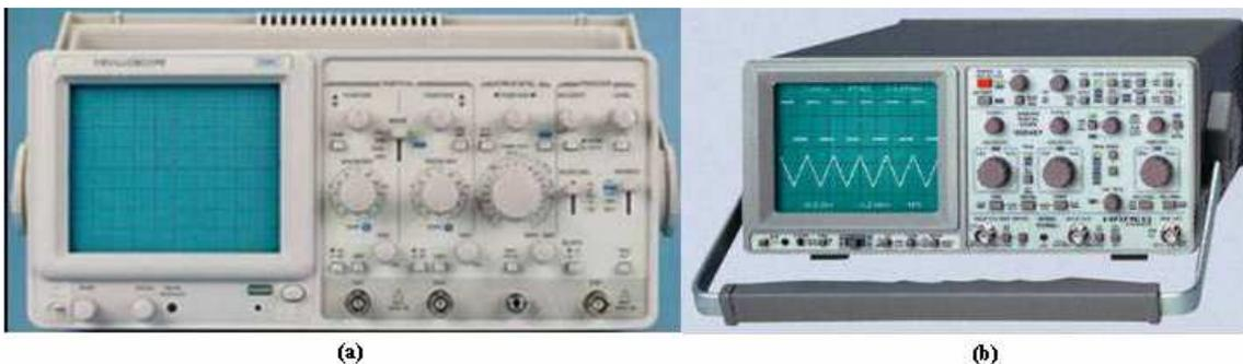
**Figura 1.1** (a) Osciloscopio analógico de 2 canales, 20 MHz. (b) Osciloscopio analógico/digital de 2 canales, 150 MHz.
