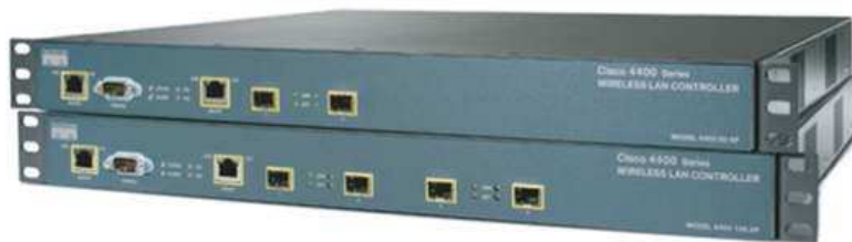
Figura 3.13 Cisco Wireless LAN Controller (WLC) Serie 4400 [35]
