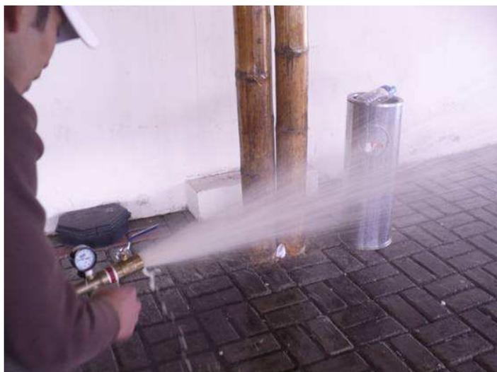
**Figura 8.** Pruebas de presión realizadas en las BIEs
