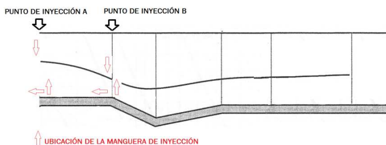
FIGURA 2.10 ESQUEMA DE LA UBICACIÓN DE LOS PUNTOS DE INYECCIÓN DE LA SOLUCIÓN DE CLORURO DE SODIO
