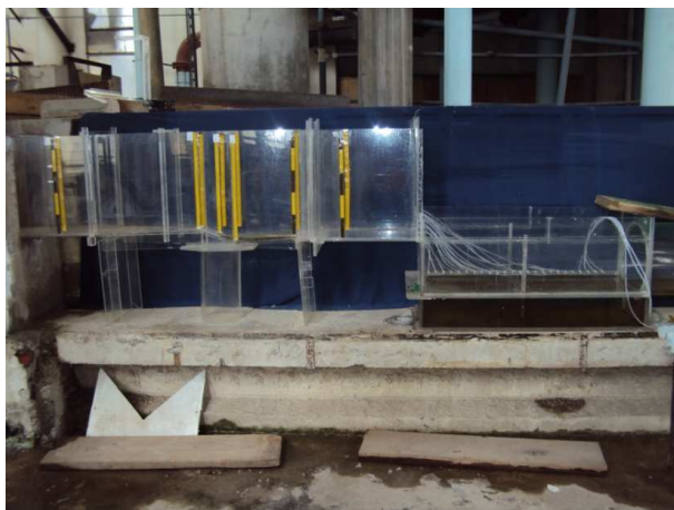
FIGURA 2.6 AFORADOR PARSHALL Y TANQUE DE DESCARGA
