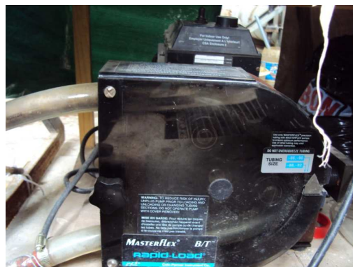
FIGURA 2.9 BOMBA PERISTÁLTICA COLE PALMER MASTER FLEX
