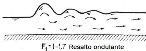
FIGURA 1.20 TIPOS DE RESALTO HIDRÁULICO
