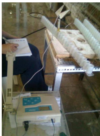
FIGURA 2.16 MEDICIÓN DE LA CONDUCTIVIDAD ELÉCTRICA DE LAS MUESTRAS
