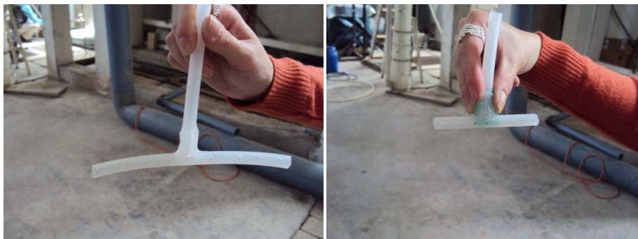
FIGURA 2.11 MANGUERAS DE INYECCIÓN SOLUCIÓN DE CLORURO DE SODIO
