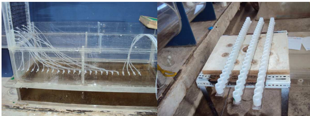
FIGURA 2.15 RECIPIENTES PLÁSTICOS Y MANGUERAS PARA LA TOMA DE MUESTRAS
