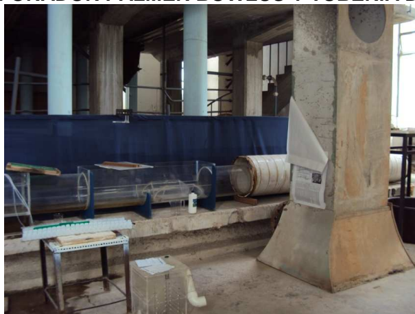
FIGURA 2.7 AFORADOR PALMER BOWLUS Y TUBERÍA DE DESCARGA
