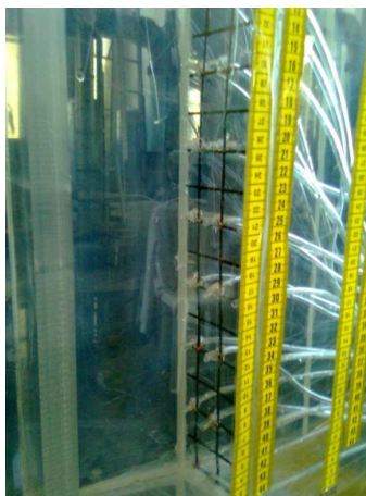
FIGURA 2.12 MALLAS Y MANGUERAS PARA LA TOMA DE MUESTRAS
