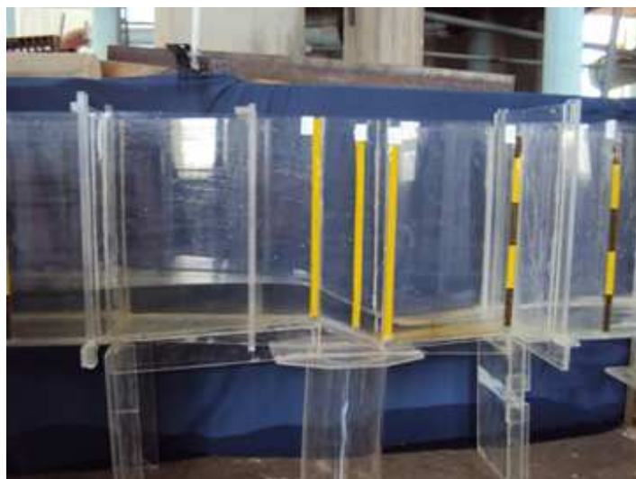
FIGURA 3.1 AFORADOR PARSHALL EN FUNCIONAMIENTO
