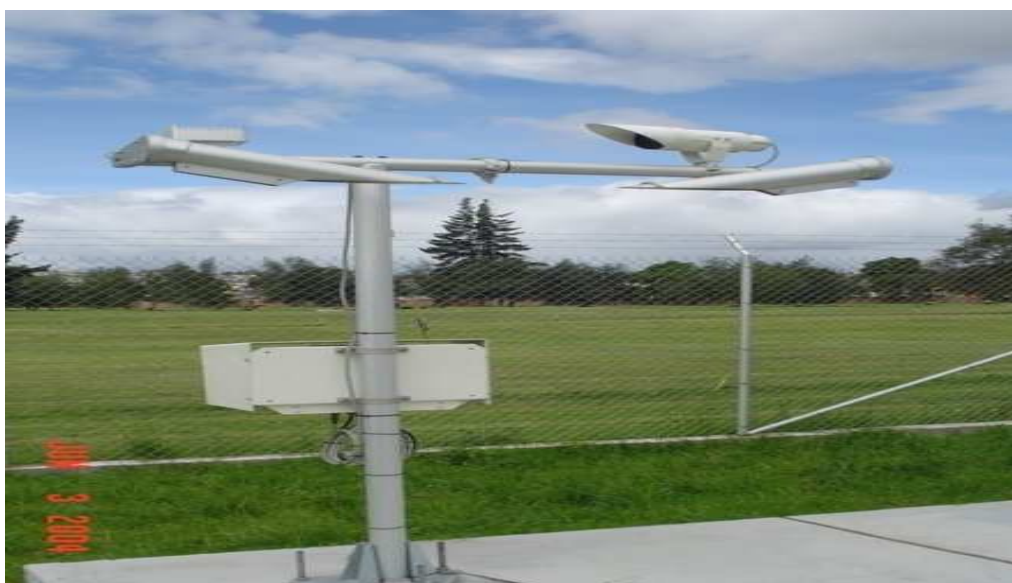
Fig. 2.1 Pluviómetro, sensor para medir la cantidad de precipitación
