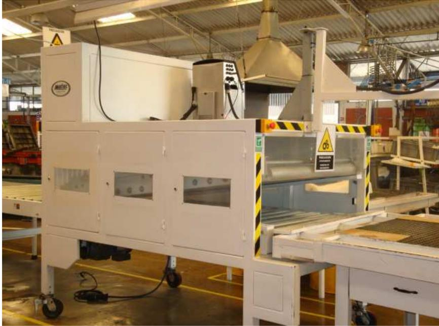
**Figura 3.7.** Mesa de rodillos en la línea de producción de poliuretanos
