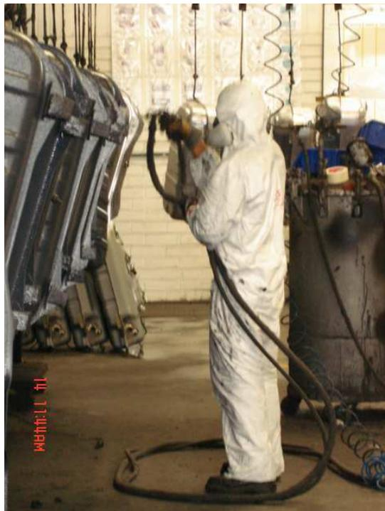
**Figura 3.11** Equipos de protección para aplicación de pintura en la línea de subensamble de tanques de combustible
