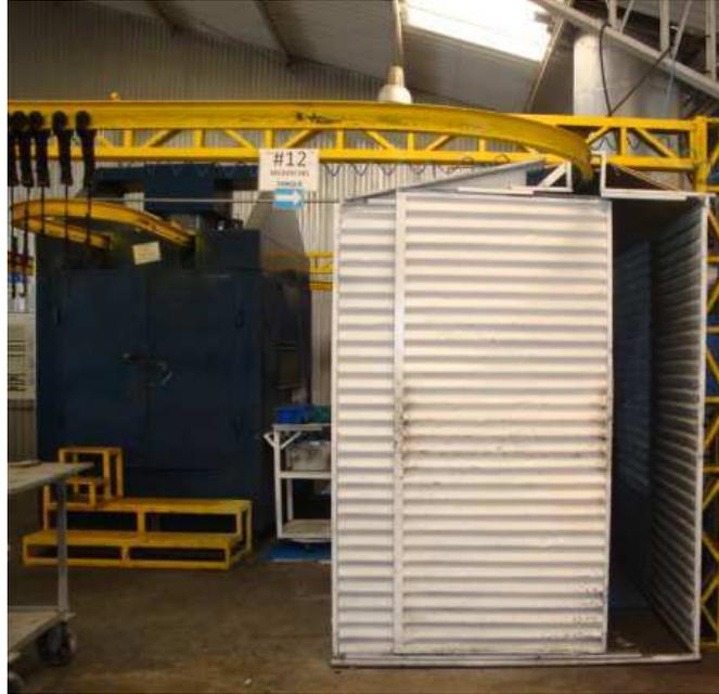
**Figura 3.8** Cámara de aislamiento acústico en la línea de Subensamble de tanques de combustible
