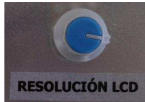
Fig. 25 Perilla que permite el cambio de contraste en la LCD.
