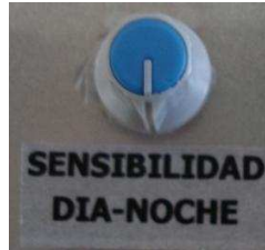
Fig. 27 Perilla que permite trabajar el rango de luz.
