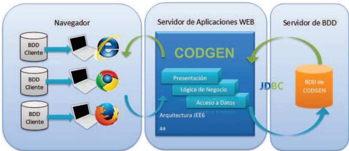
Figura 34 Arquitectura y Funcionamiento de la Aplicación CODGEN 53
