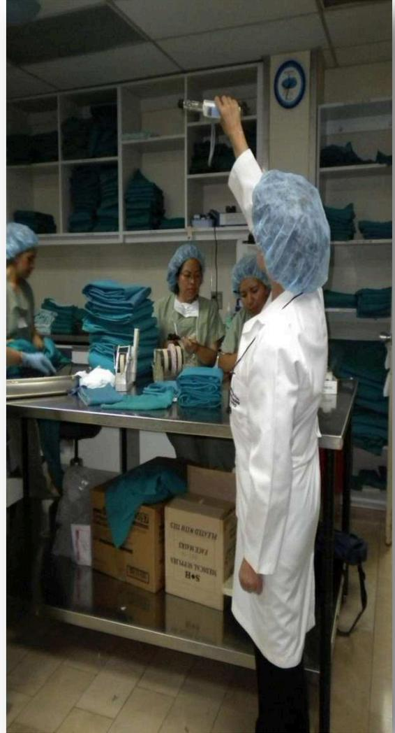
**Figuras No. 3 y 4** Evaluación térmica ambiental con monitor portátil Kem WBGT -103
