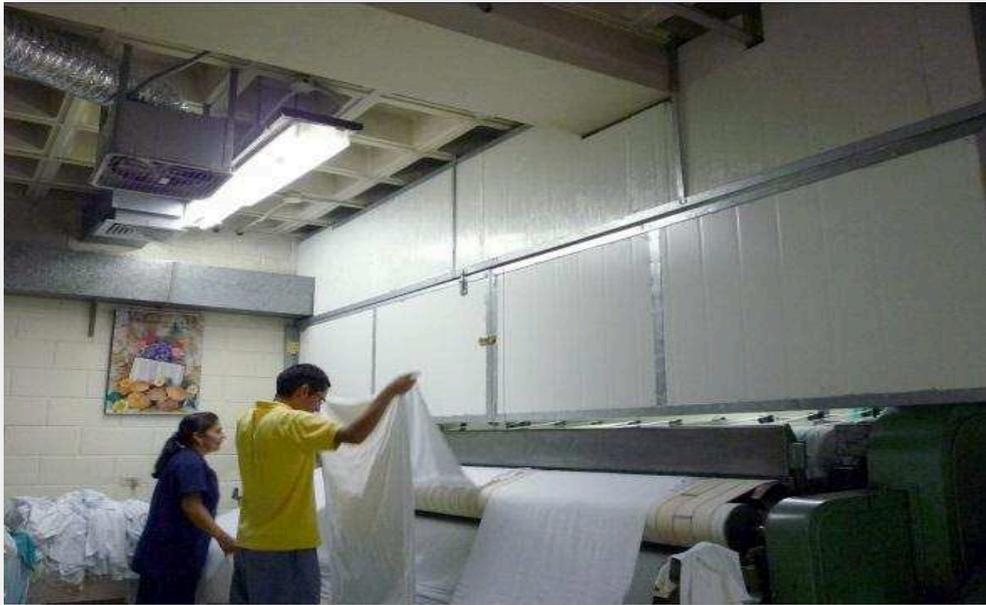
**Figura No. 9** Calandria apantallada y sistema de ventilación
