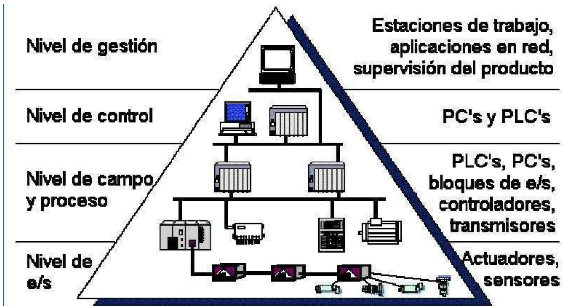
Figura 4.6 Niveles del sistema Scada [20].
