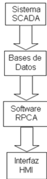
Figura 4.18 Esquema del software RPCA en Matlab
