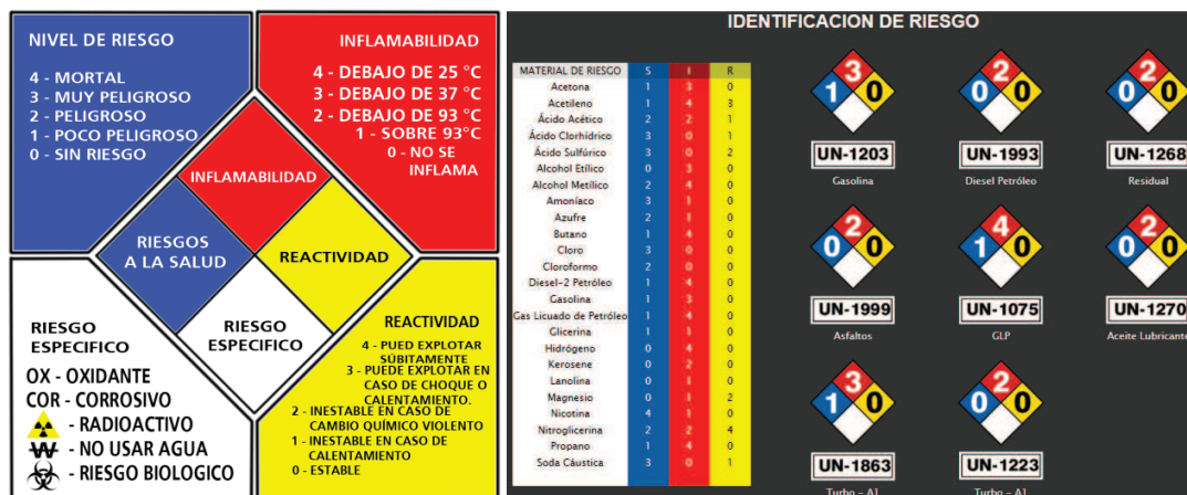
Figura 3.39 Rombo de identificación de riesgo para productos transportados NFPA 704
