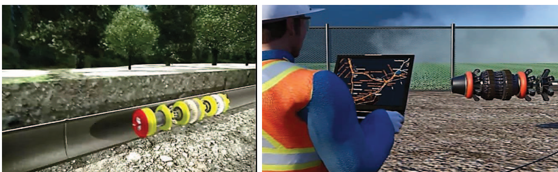
Figura 2.4 Inspección Interna de tuberías (ILI) 5
