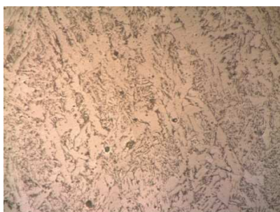
Figura 24. Micrografía de la soldadura (500x)
