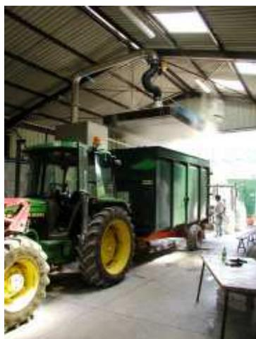
**Figura 13** Remolque en acero de 16000 L.
