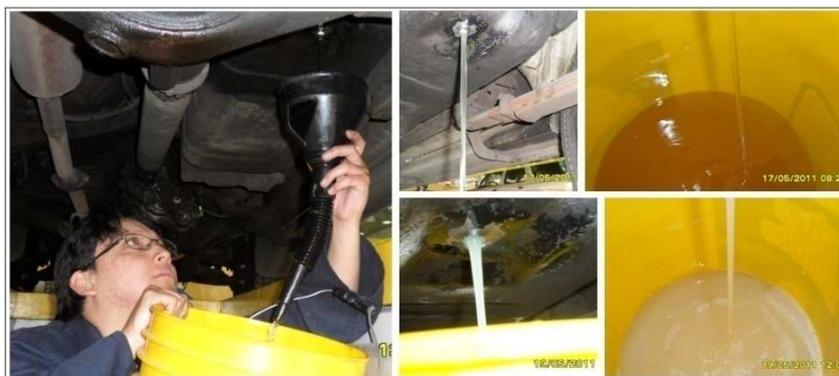
**Figura 4-52:** Descarga de combustible para determinar el consumo de combustible.
