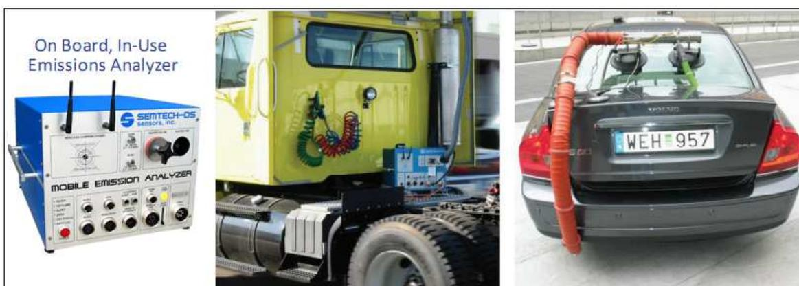
**Figura 4-7:** Equipo de medición a bordo de emisiones vehiculares.<sup>111</sup>
