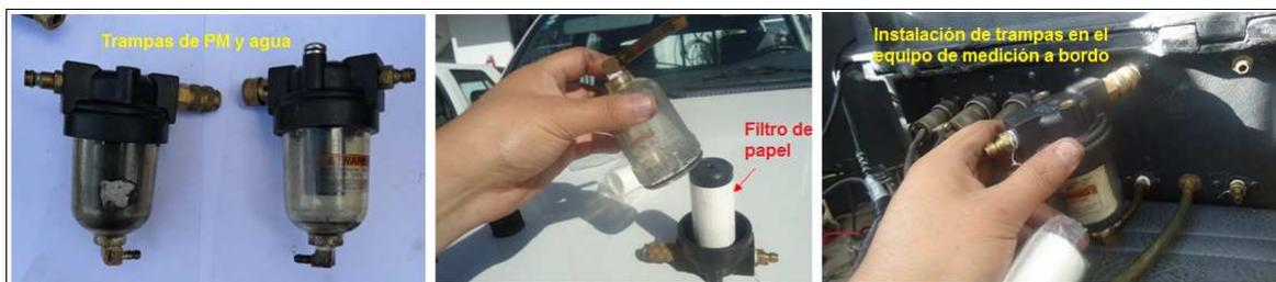
**Figura 4-34:** Instalación de trampas de agua y de PM en el equipo de medición a bordo.
