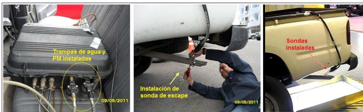
**Figura 4-35:** Instalación de sondas a la salida del tubo de escape del vehículo de pruebas.
