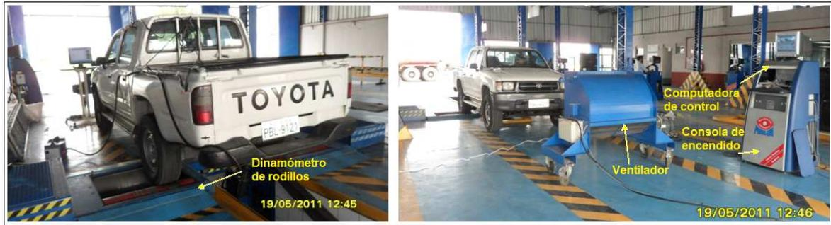
**Figura 4-41:** Verificación de funcionamiento del dinamómetro de rodillos LPS 3000 y opacímetro LON.
