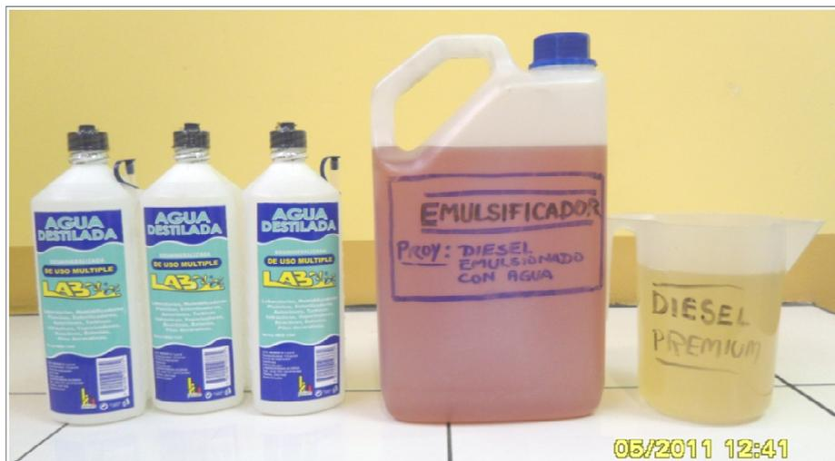
**Figura 4-42:** Componentes para obtener el diesel microemulsionado con agua.
