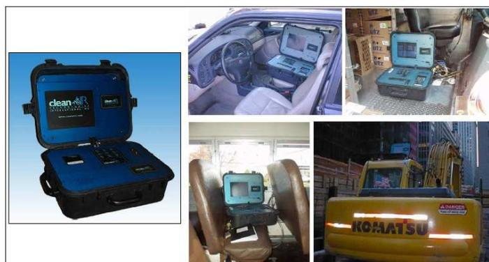
**Figura 4-11:** Ejemplo de localización de la instalación del equipo Montana System OEM 2100.<sup>125</sup>
