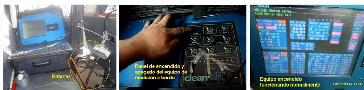
**Figura 4-37:** Encendido del equipo de medición a bordo Montana System OEM 2100.
