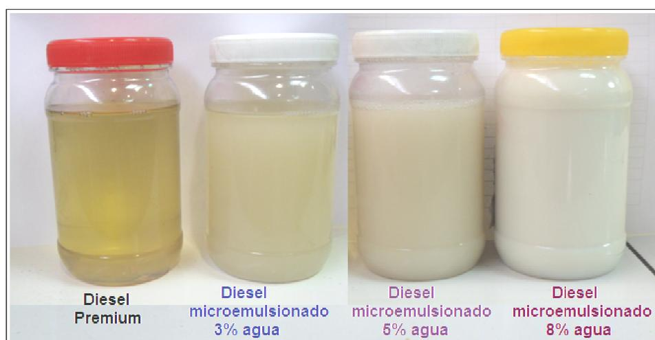
**Figura 4-49:** Color del diesel microemulsionado con diferentes porcentajes (%V) de agua. <sup>155</sup>
