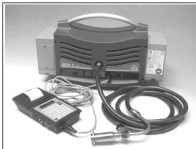
**Figura 4-19:** Equipo de medición de opacidad - opacómetro MAHA MDO2.<sup>133</sup>
