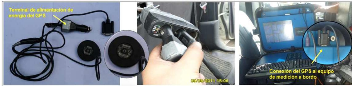
**Figura 4-32:** Conexión del GPS al equipo de medición a bordo Montana System OEM 2100.
