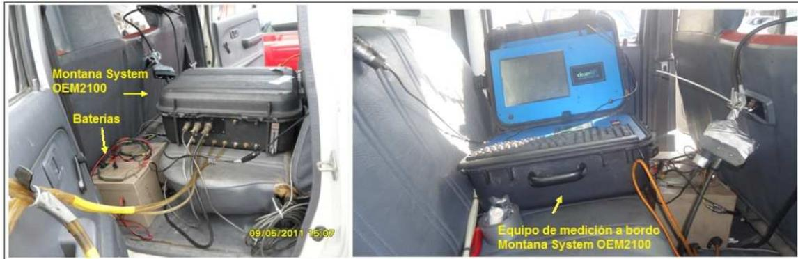
**Figura 4-27:** Ubicación de equipo de medición a bordo y baterías dentro del vehículo de pruebas.
