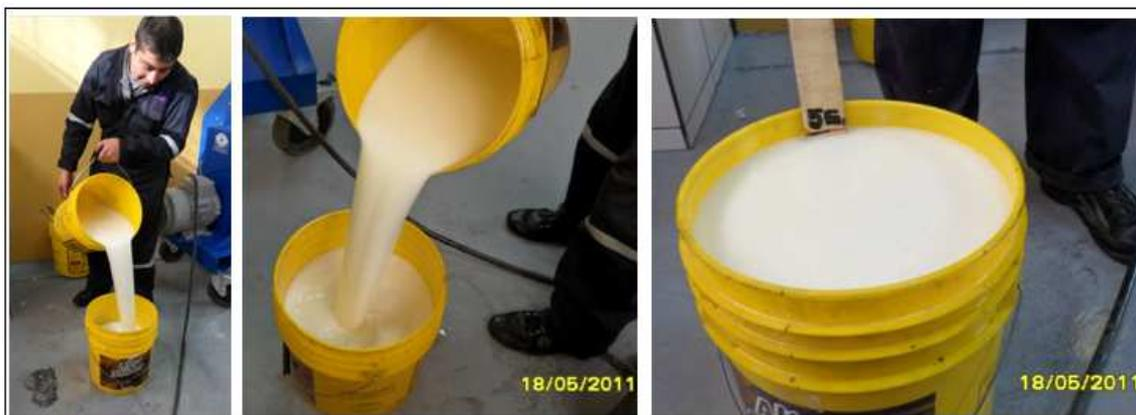
**Figura 4-48:** Diesel Premium microemulsionado con agua (8% V de agua).
