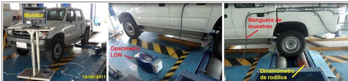
**Figura 4-39:** Instalación del opacímetro para la medición de opacidad dinámica.
