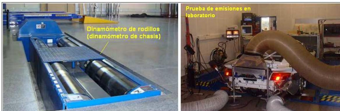
**Figura 4-5:** Laboratorio de emisiones con un vehículo ubicado sobre el dinamómetro de chasis.<sup>109</sup>
