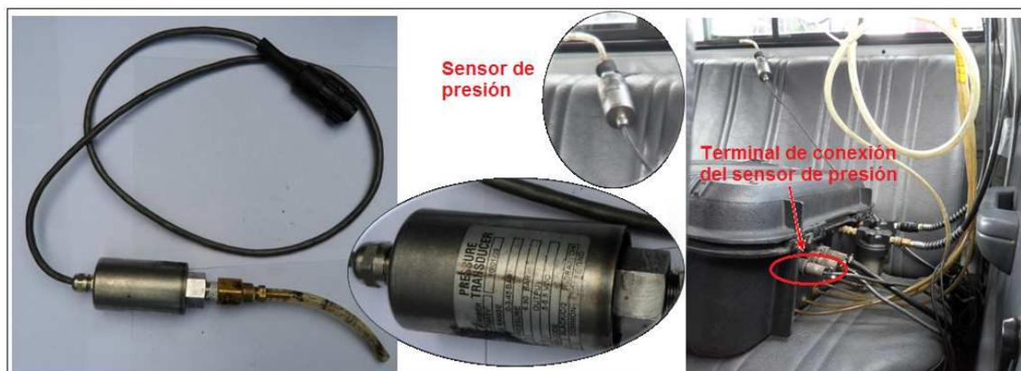
**Figura 4-31:** Instalación y conexión del sensor de presión del equipo de medición a bordo.
