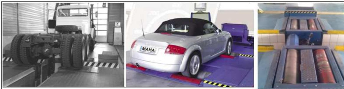
**Figura 4-13:** Vehículos sobre el dinamómetro de rodillos LPS 3000.<sup>127</sup>
