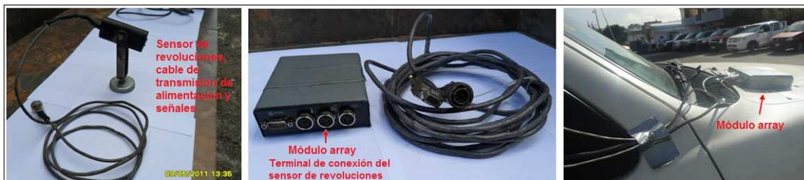
**Figura 4-29:** Conexión del sensor de revoluciones al módulo array del equipo de medición a bordo.
