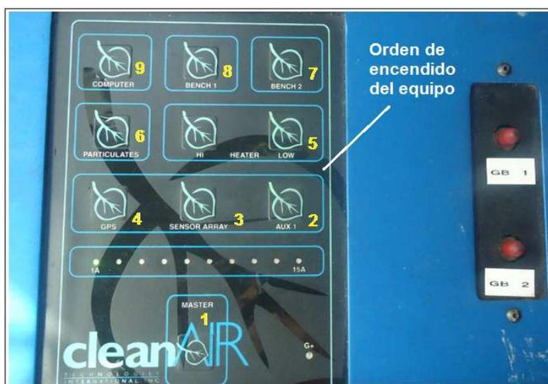
**Figura 4-36:** Orden de encendido del equipo de medición a bordo Montana System OEM 2100.
