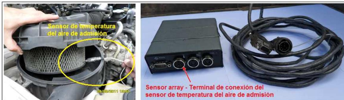
**Figura 4-30:** Instalación y conexión del sensor de temperatura del aire de admisión.
