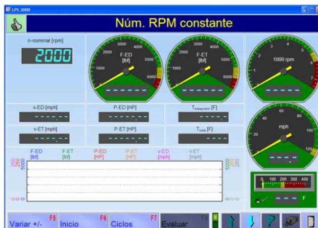
**Figura 4-16:** Pantalla de sincronización de las revoluciones del motor con el software LPS 3000.<sup>130</sup>
