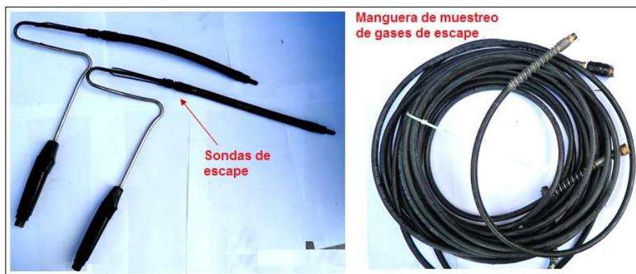
**Figura 4-33:** Sondeas de escape y mangueras de muestreo del equipo a bordo.
