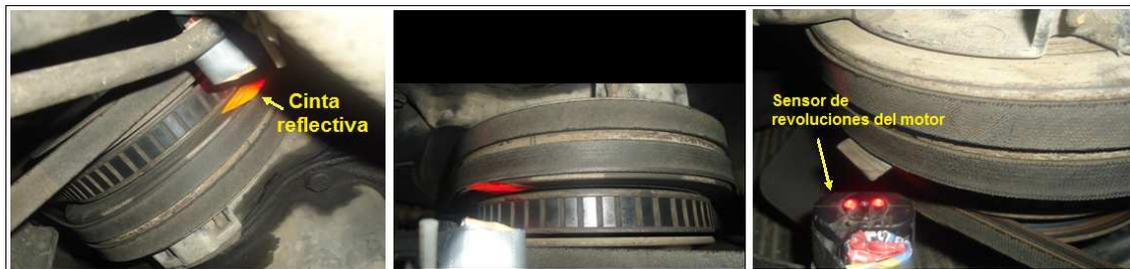
**Figura 4-28:** Instalación del sensor de revoluciones y cinta reflectiva sobre el cigüeñal del motor.
