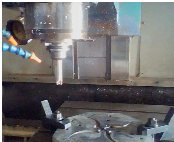
Fig.5. 3. Esquema de montaje de la placa en la mesa de la CNC
