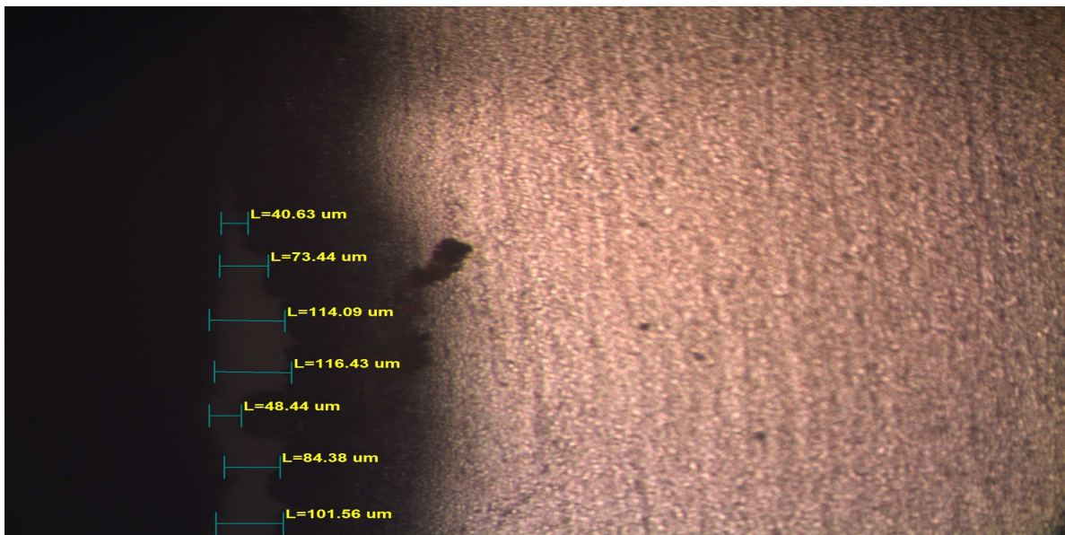
Fotografía N°3.2 Acero de matriz ferrítica perlítica con bajo contenido de carbono, se observa que el recubrimiento epóxico sufre un proceso de disminución de espesor 100X
