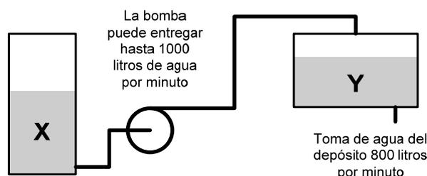
**Figura 2.1.** Capacidad inicial versus funcionamiento deseado
