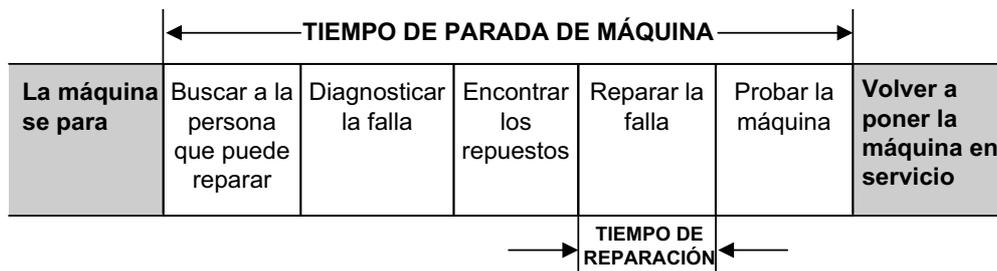
**Figura 2.14.** Tiempo de parada de máquina vs. tiempo de reparación
