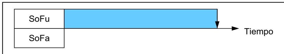
**Figura 1.14.** Perfil de funcionabilidad de un sistema de ingeniería no recuperable
