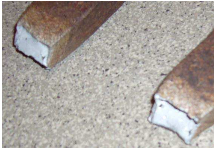
Figura 4.13 - Sección de falla en probetas a tracción
