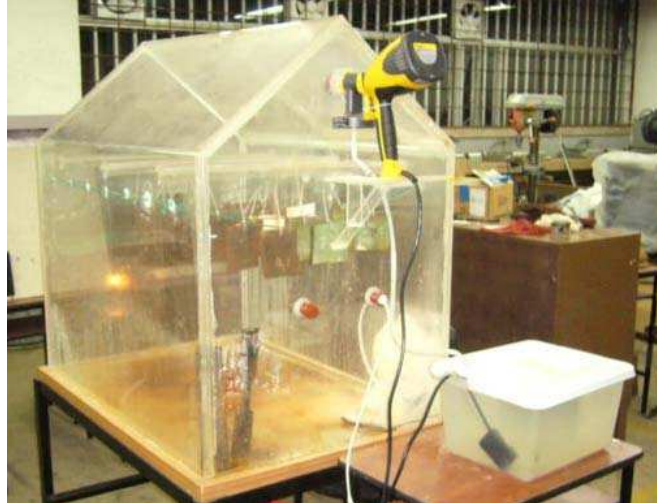
Figura 3.5 - Cámara de niebla salina operando
