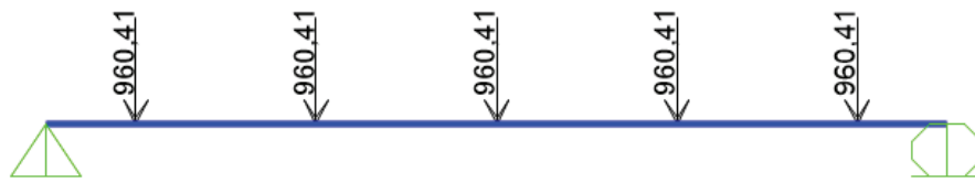
Figura 4.8. Carga muerta puntual producto de los durmientes
