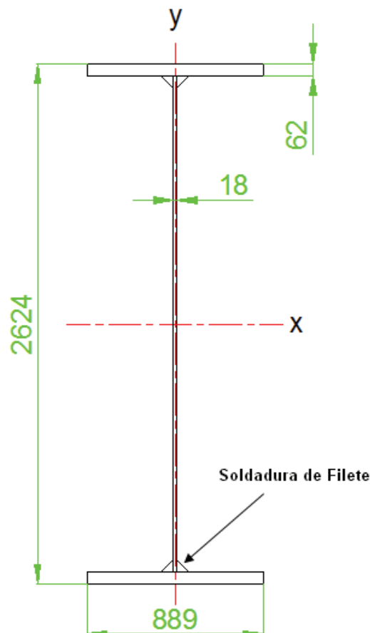
Figura 5.17. Conexión alma-patín de la trabe principal
