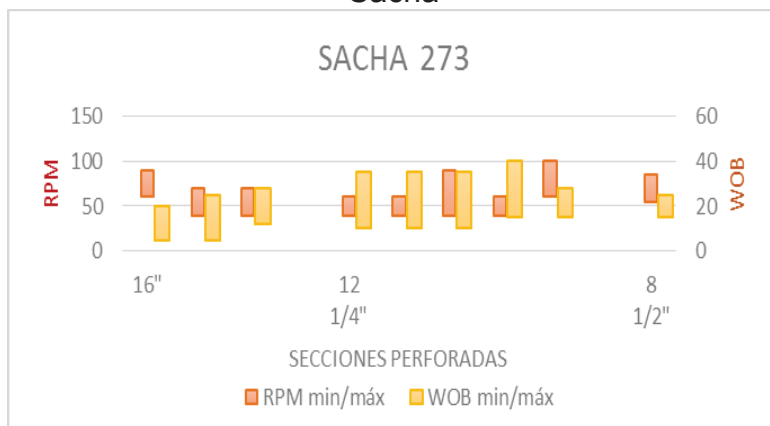
Figura 61: Parámetros operacionales RPM y WOB de los pozos del Campo Sacha
