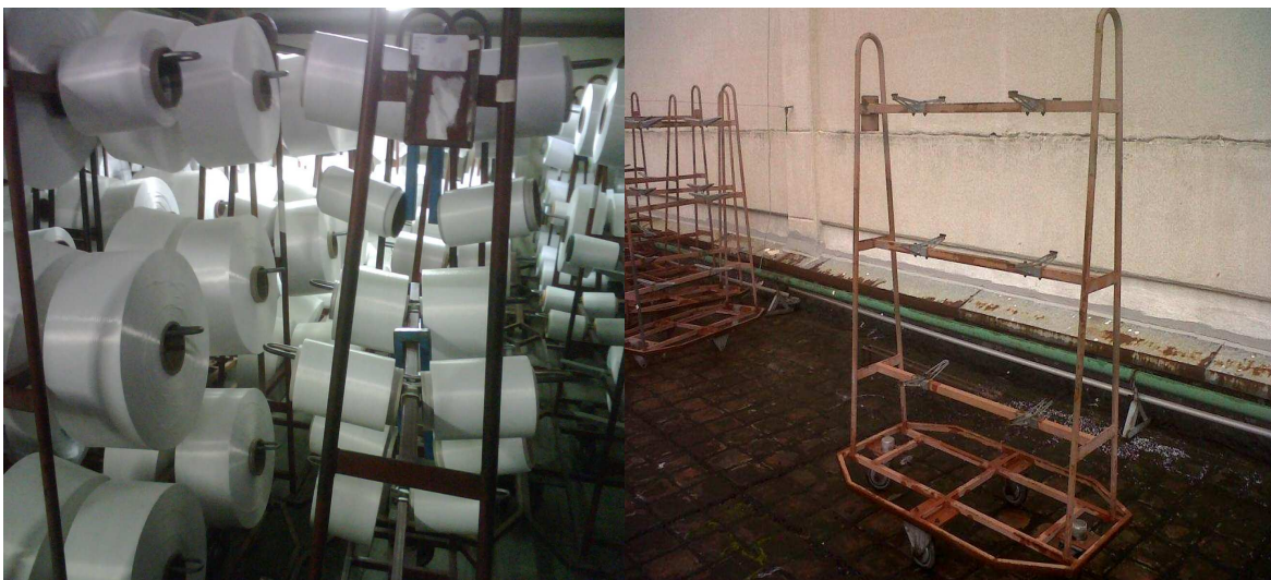
Figura 25. Coches de transporte de POY con 12 púas.
