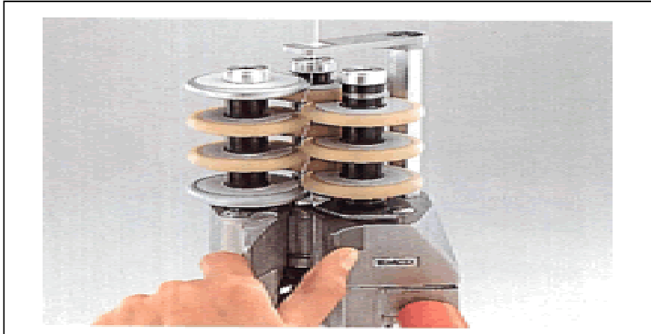
Figura 3. Unidad texturizadora con discos de fricción de poliuretano.
