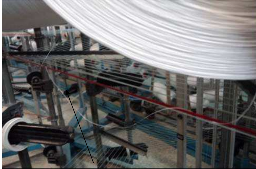
Figura 48. Cola de transferencia con empalme
