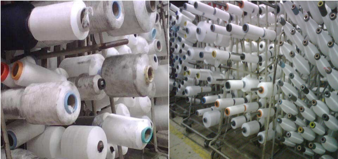
Figura 36. Producto defectuoso con manchas y cortas del Texturizado
