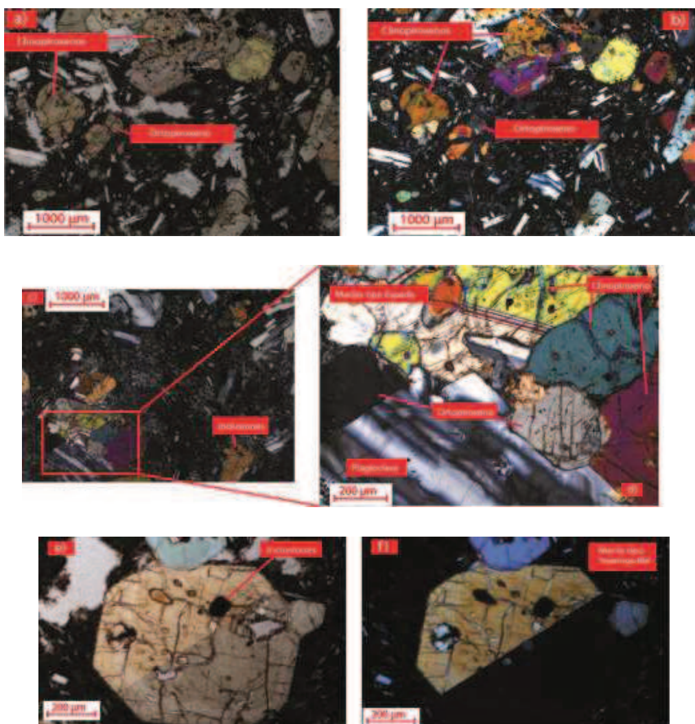
Figura 4.13. Imágenes microscópicas de los cristales de piroxenos presentes en las rocas del depósito lahárico Mera, a) Imagen sin nicoles, b) Imagen con nicoles cruzados, cristales de clinopiroxenos (birrefringencia media-alta) y ortopiroxenos (birrefringencia baja) (Huaymayacu UTM 0814350mE/9842446mN), c y d) Imágenes con nicoles cruzados de cristales de clinopiroxenos (inclusiones imagen derecha) y ortopiroxenos y plagioclasas (Alpayacu UTM 822461mE/ 9838525mN) e) Piroxeno el cual presenta macla tipo “Espinguilla o Espada” y fracturación. Imagen sin nicoles, f) Imagen con nicoles cruzados (Moravia UTM 0824868mE/9835460mN).
