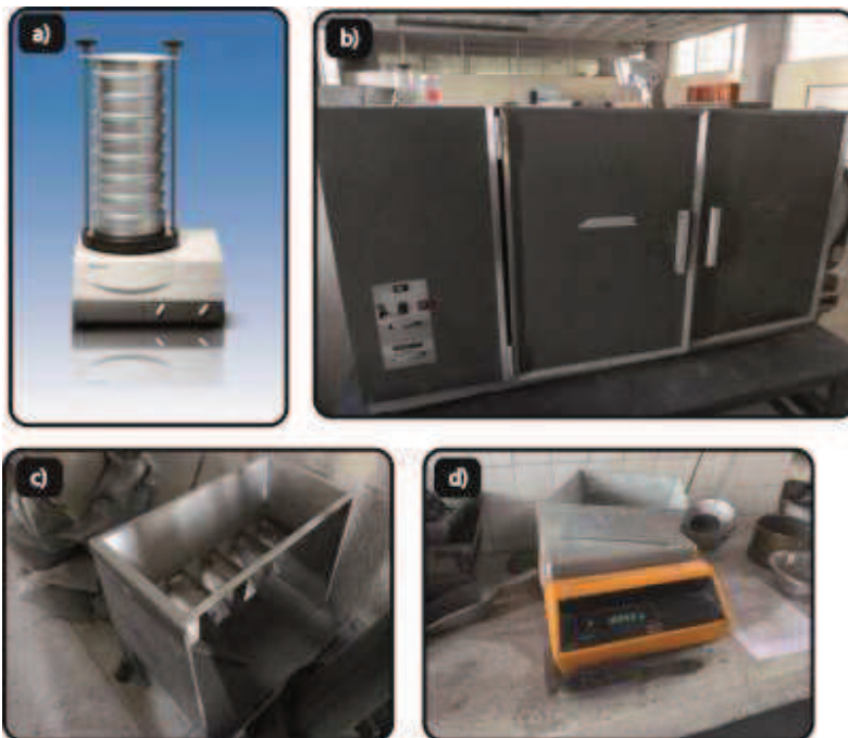
Figura 4.18. Equipos utilizados para el tamizado, cuarteo, secado y pesado de las muestras de las de matriz para obtener la granulometría. a) Columna vibradora de tamices, b) Horno, c) Cuarteadora, d) Balanza.
